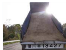
ダンプトラックの保護対策(二重シート)
