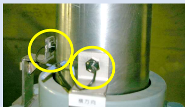
渦電流変位計（センサ） 黄色丸部分
