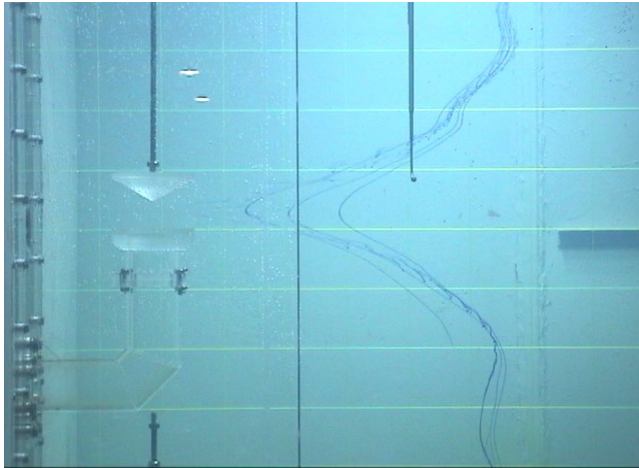
取水設備流入部周辺の流況を調査するための実験状況
