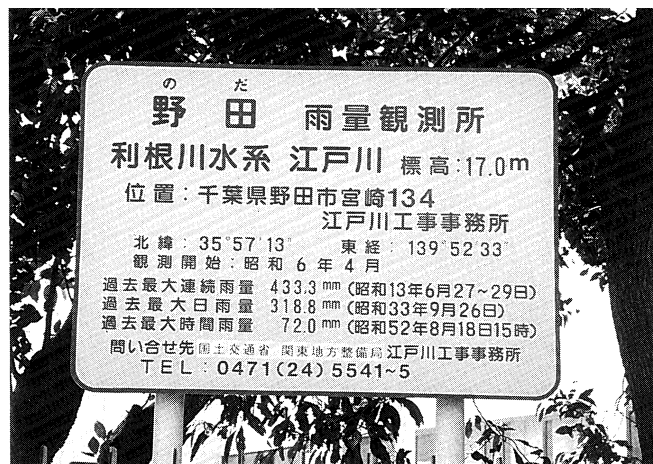
図2・4・1 標識の一例（横100cm、たて70cm、アルミ製）
