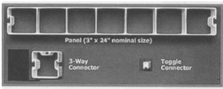
図 2.1.6 ACCS システムの断面
