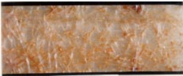
図 - 2 . 5 高湿度劣化試験後の外観 (Type2,60 85%210日間)
