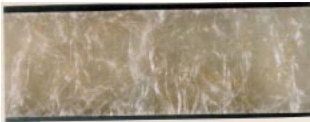
図 - 2 . 4 水中浸せき試験後の外観 (Type2,60 210日間)
