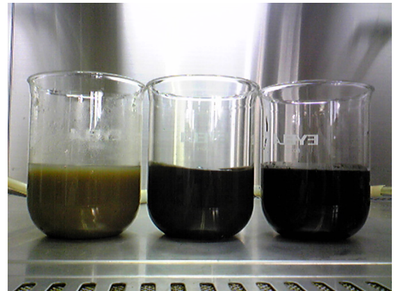
図-5.1.1 汚泥の外観 (左) E 処理場：余剰汚泥 (中央) B 処理場：初沈汚泥, (右) B 処理場：余剰汚泥
