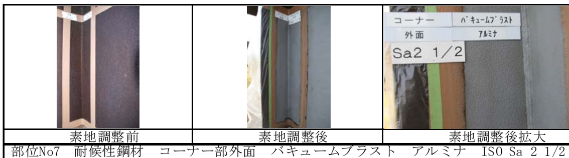
図-4.4.10 バキュームブラスト処理状態 (1)
