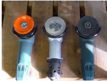
超合金サンダー・ダイヤモンドツール・ペーパーサンダー 写真-4.4.3 動力工具
