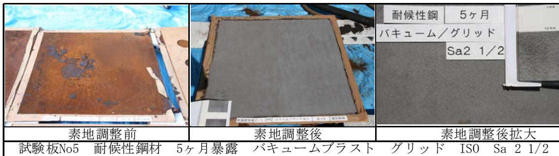
写真-4.4.4 バキュームブラスト処理実施状況
