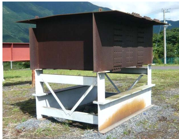
写真-4.4.7 耐候性鋼材模擬ブロック試験体
