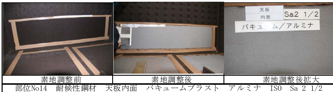
図-4.4.10 バキュームブラスト処理状態(2)
