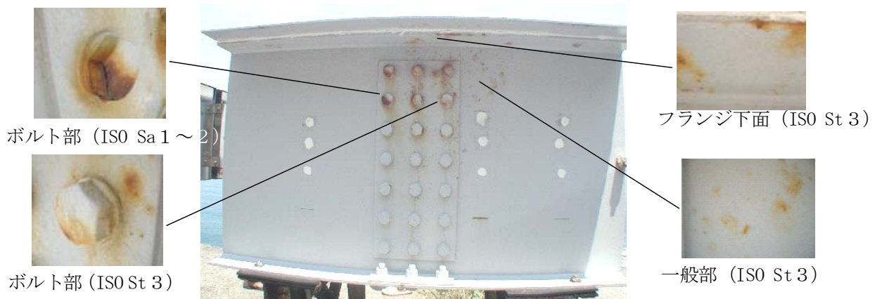
JIS 耐候性鋼材試験体
