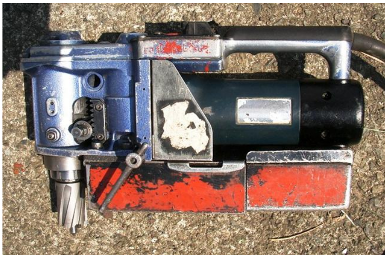
写真-4.5.1 コア採取機 (穴あけ機 ; 穴径 30mm \phi )
