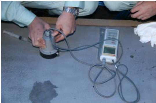
写真-4.4.5 付着塩分量の測定
