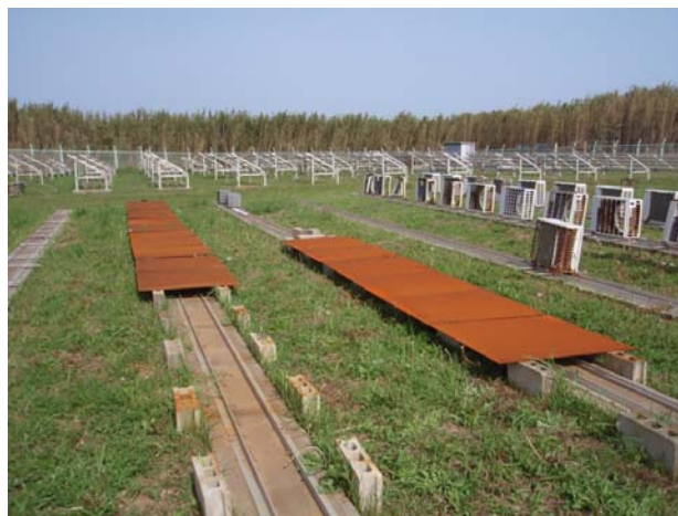
写真-4.4.2 飯岡暴露場 (海岸から約100m)
