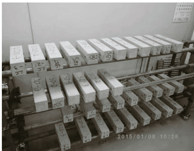
写真 5.2.1 供試体の保存の様子
