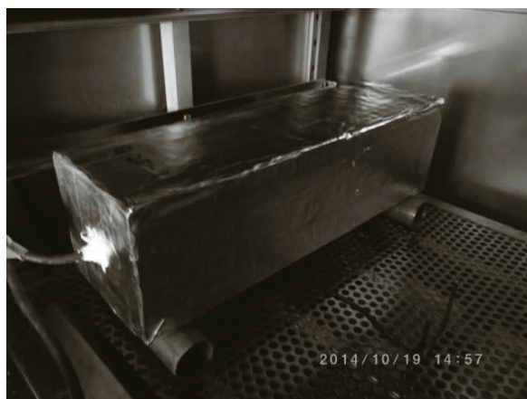
写真 5.4.1 環境槽内に静置された供試体の様子
