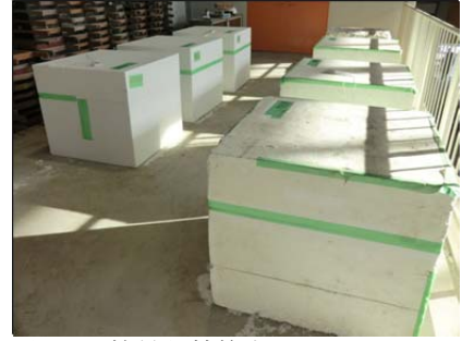
(B)発泡スチロール製の容器を用いた簡易断熱養生
