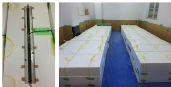
写真-1 鉄筋拘束試験の実施状況
