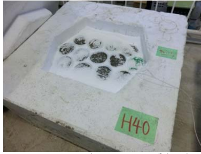
(B)発泡スチロール製の容器を用いた簡易断熱養生
