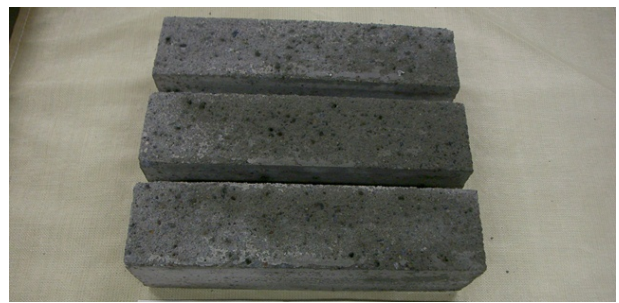
図-8 凍結融解試験における相対動弾性係数、質量変化率及びスケーリングの状況 (2)
