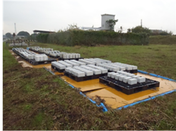
図-3 つくばでの暴露試験の状況
