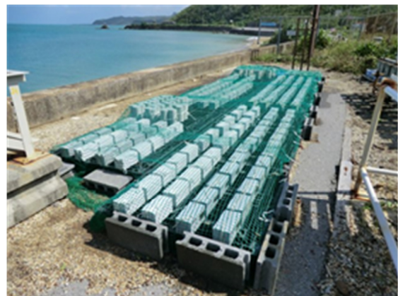
図-5 沖縄での暴露試験の状況
