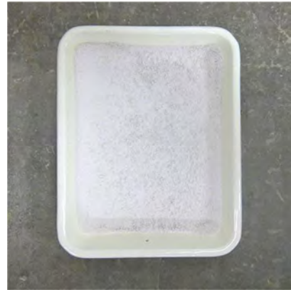
高炉スラグ微粉末 4000 (無水せつこうを三酸化硫黄(SO 3 ) 換算で2.0%内添)
