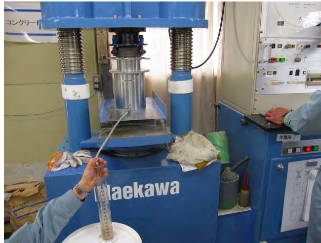
写真-7 加圧ブリーディング試験状況
