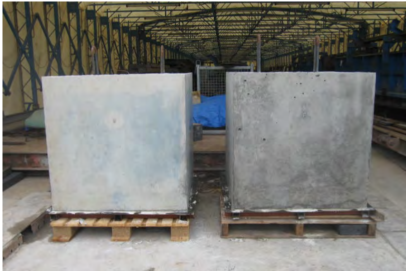
(左：高炉スラグ微粉末を高含有したコンクリート，右：普通コンクリート)
