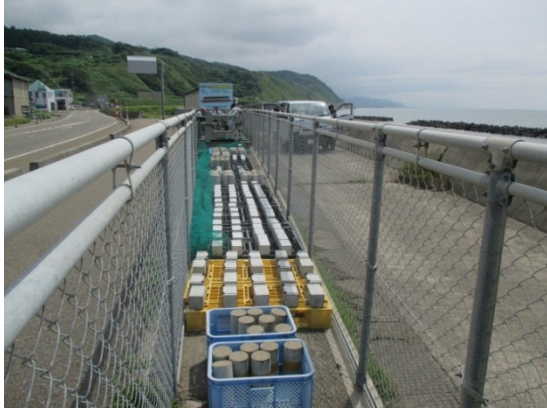
写真-2 新潟での暴露試験の状況
