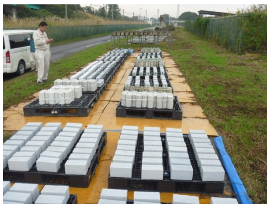
写真-1 つくばでの暴露試験の状況
