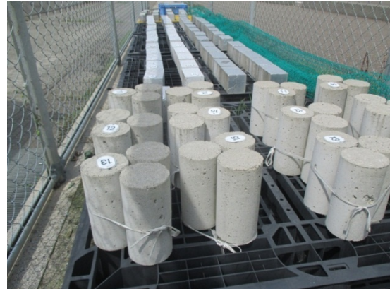
写真-2 新潟での暴露試験の状況
