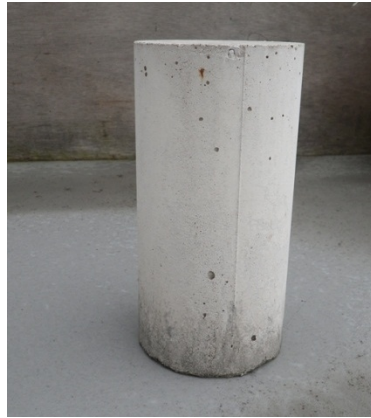
図-11 大成建設（株）技術センター内での3.5年間暴露したB77E7C7L9の状況
