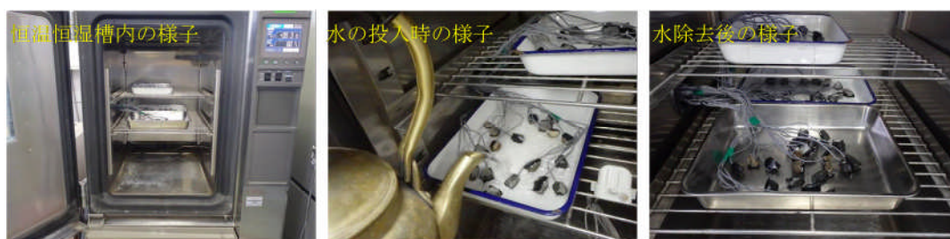
写真 3.2.1.2 乾燥収縮率試験粗(恒温恒湿槽への設置状況)
