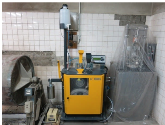
写真 3.3.2.1 促進研磨試験機
