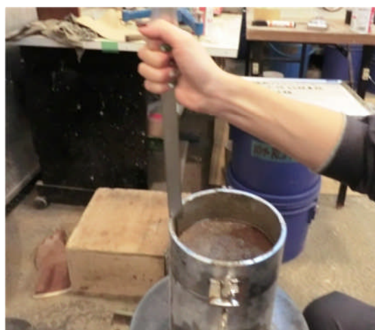
写真 4.4.1.2 沈下量の測定
