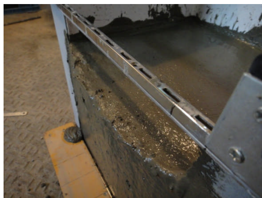
写真 4.5.1.2 エッジスランプ, オーバーフローの状況
