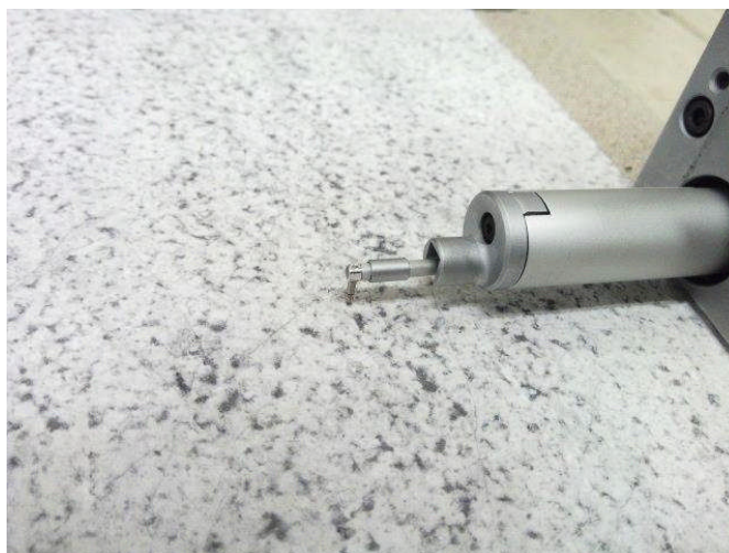
写真 7.3.2.13 サーフテスタ、測定針部分
