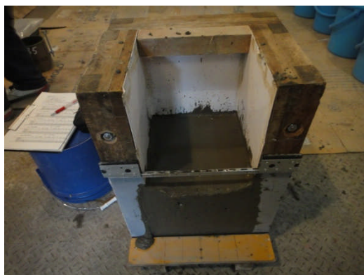
写真 4.5.1.1 ボックス型枠
