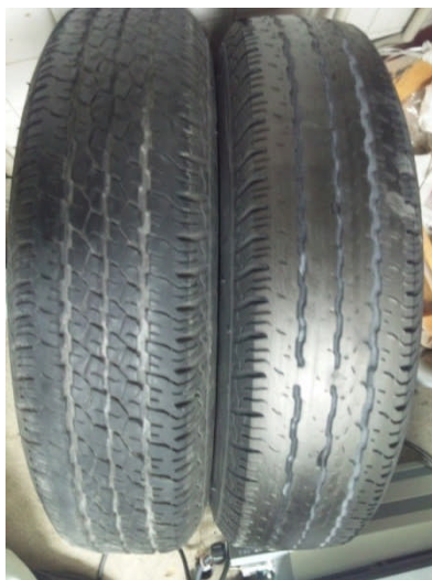
写真 7.3.1.4 試験タイヤ(左は新品、右が 17 万回時点のタイヤ)
