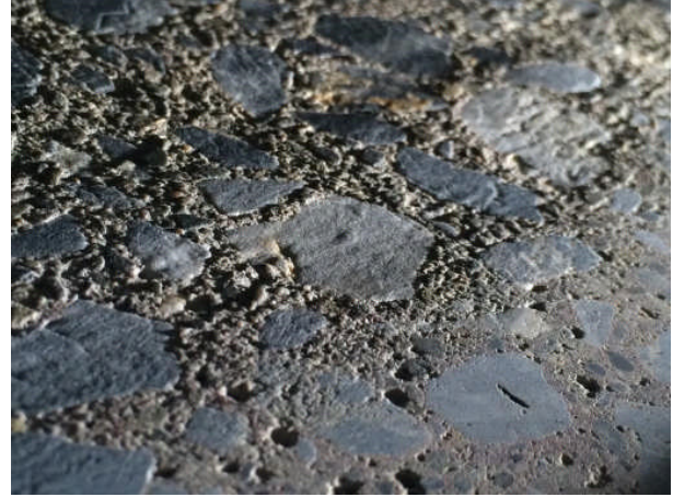
写真 6.4.2.2 実験終了後の表面の写真(LD)
