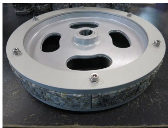
写真 3.3.2.4 骨材をリングにセット
