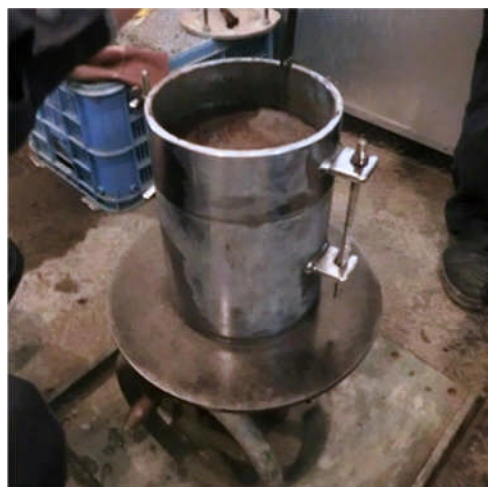
写真 4.4.1.1 締固め性・変形性試験の器具
