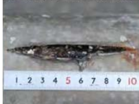
②シール材の機能低下によりチタン箔が剥離が観察される。
