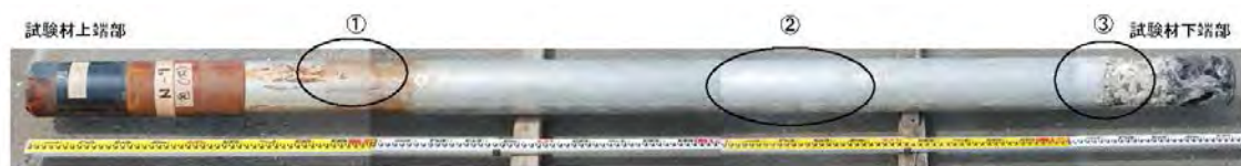
①補修部(もらい錆による変色はあるが、溶接部とも異状なし)
