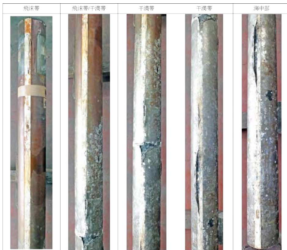
写真-3.3.15.7 N-15 試験材(東側)の各部(飛沫部~海中部)の外観
