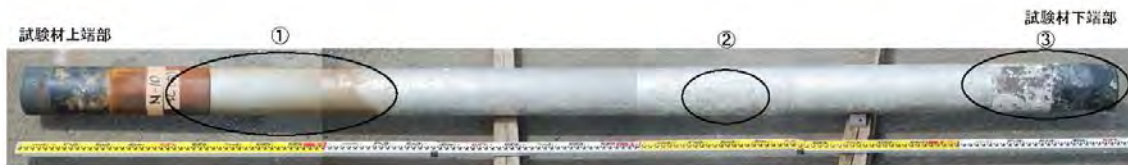
①飛沫帯の試験材表面には、もらい錆による変色(茶褐色)が認められる
