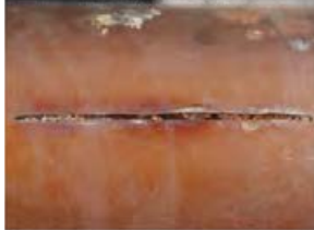
②シール材の機能低下によりチタン箔が剥離が観察される。
