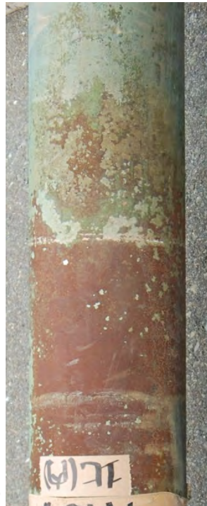
① 沫帯の試験材表面には、もらい錆による変色（茶褐色）と緑青の形成が認められる。
