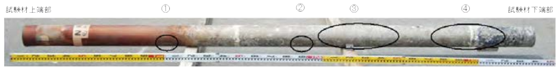
①スクラッチ傷部(浮きなどの異状は認められない)
