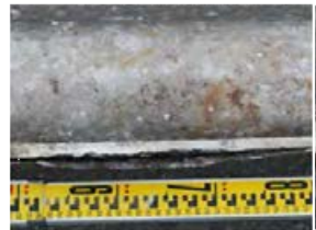
②シール材の機能低下によりチタン箔が剥離が観察される。
