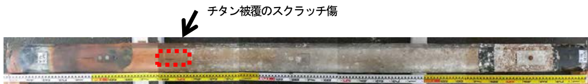
写真-3.3.14.15 T.P.+1300 施設側(北)のチタン被覆のスクラッチ傷の位置
