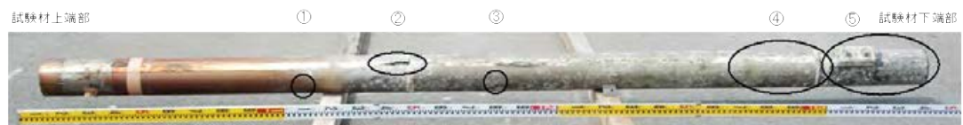
④全体的にシール材の部分欠損が認められる
