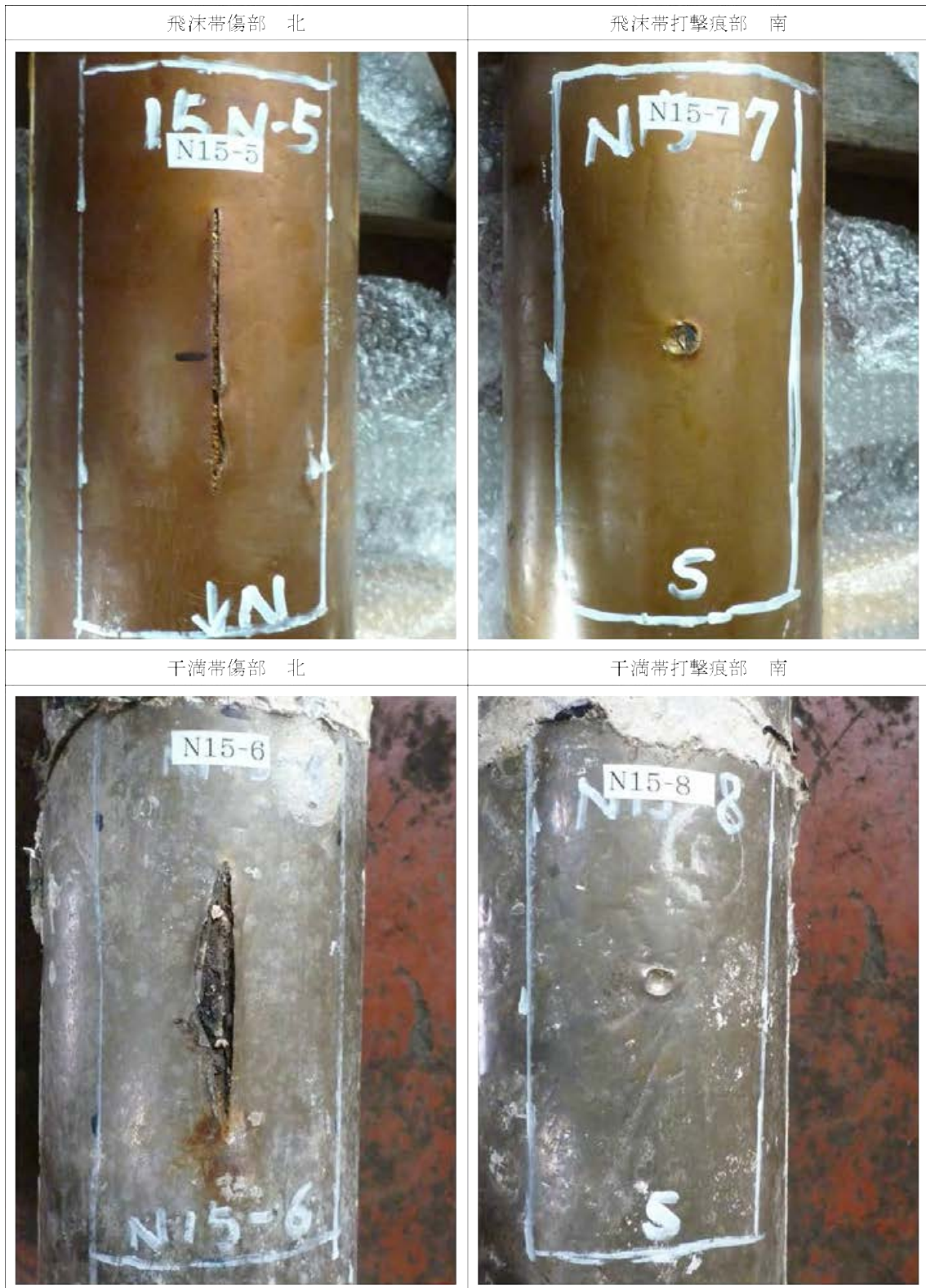
写真-3.3.15.8 試験材N-15の人工線状欠陥部および打撃痕部の外観
