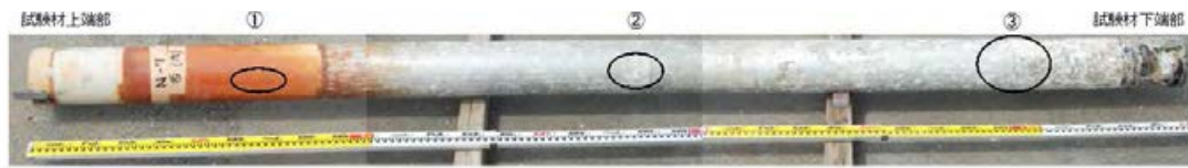
①スクラッチ傷部(飛沫帯、異状なし)
