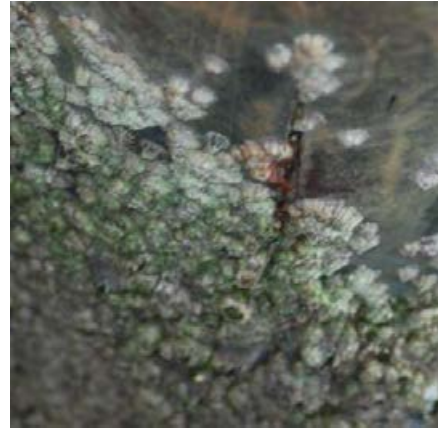
人工傷状況(スクラッチ傷)
