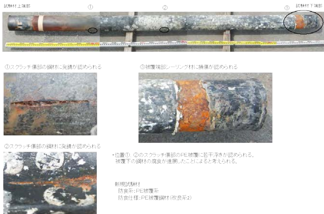
写真-3.3.5.3 試験材 N-5 の海生生物除去後の外観観察結果(東側)
