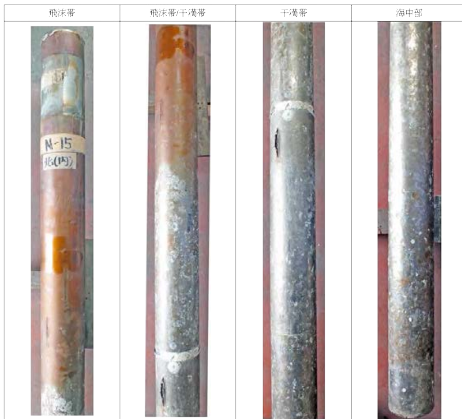
写真-3. 3. 15. 4 N-15 試験材 (西側) の各部 (飛沫部～海中部) の外観
