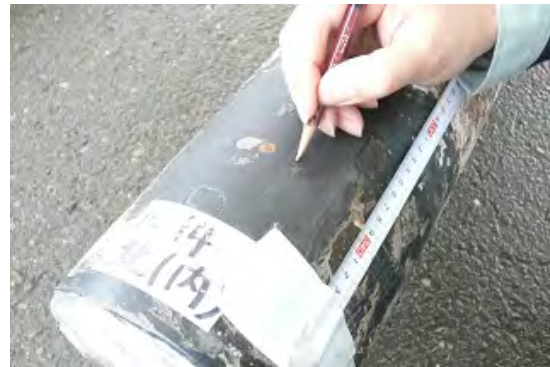
写真-3.3.14.8 鉛筆硬度測定状況
