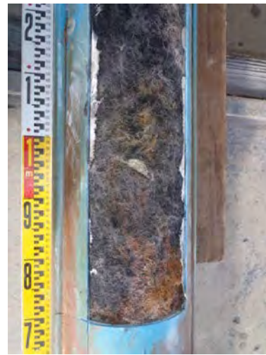
不織布およびシリコン系防食樹脂の外観状況 (部位①)
