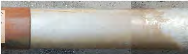
①飛沫帯の試験材表面には、もらい錆による変色(茶褐色)が認められる
