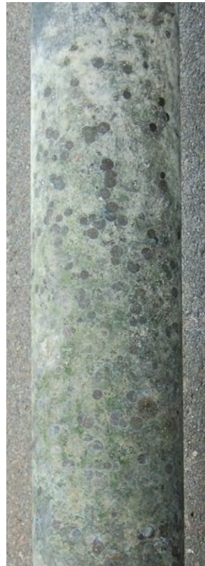
② 干満帯～海中部の試験材素地面は、全体的に暗褐色を呈する。
