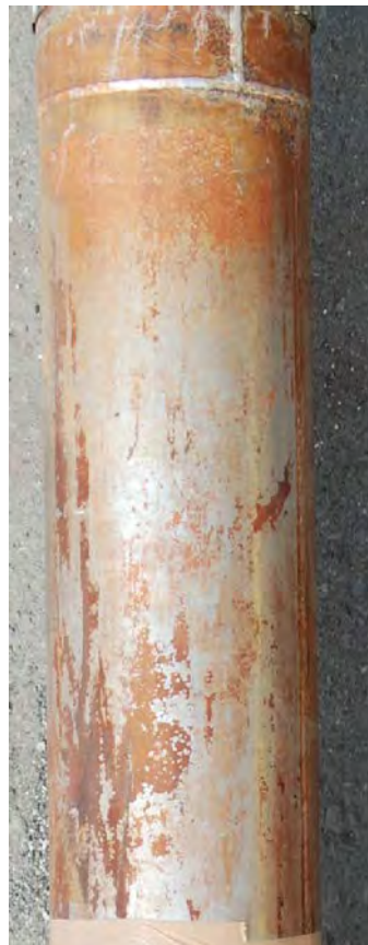
①飛沫帯の試験材表面には、もらい錆による変色(茶褐色)が認められる
