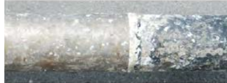
④被覆端部のシール材に一部欠損が認められる
