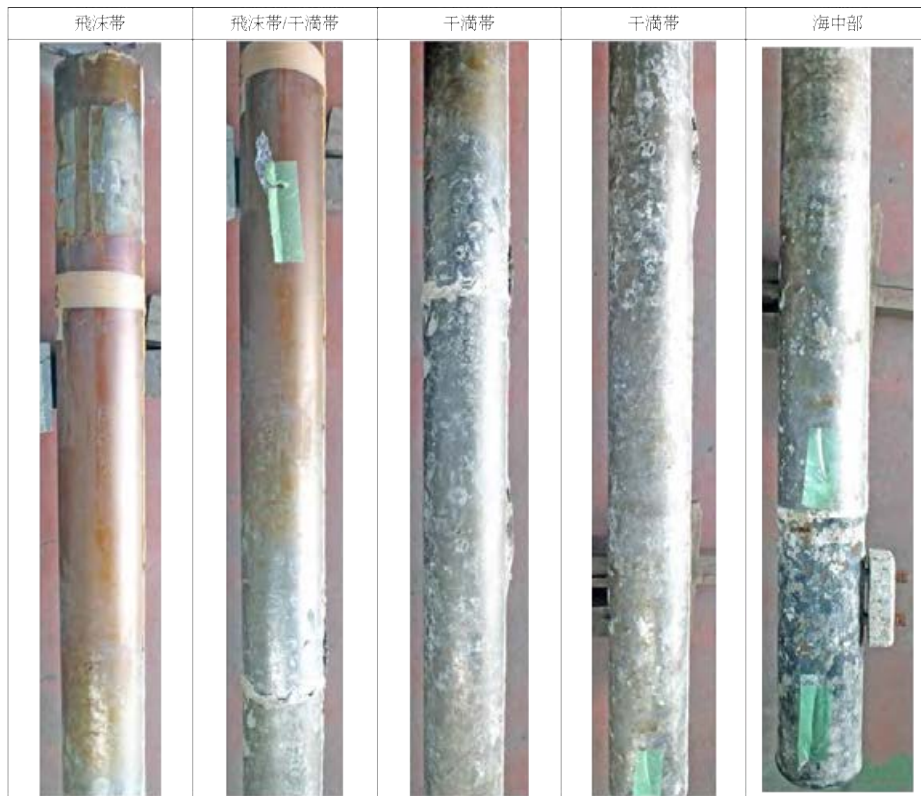
写真-3.3.16.8 N-16 試験材(東側)の各部(飛沫部~海中部の外観)
