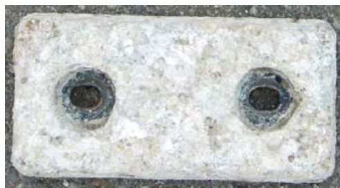
写真-3.3.14.4 陽極外観状況 (試験材 N-14)
