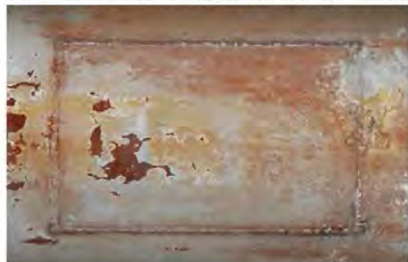
②高耐食性SUS部にすきま腐食などの局部腐食は認められない
