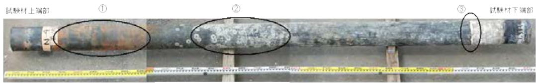
①飛沫帯の試験材表面には、もらい錆による変色(茶褐色)が認められる
