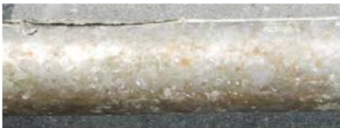
⑤シール材の機能低下によるチタン箔の剥離が認められる(約350mm)
