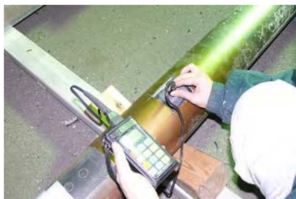
写真-3. 3. 14. 22 チタン被覆衝撃部の板厚測定状況
