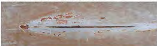
②高耐食性SUS部にすきま腐食などの局部腐食は認められない
