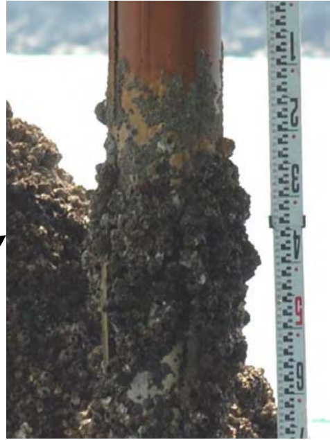
純チタン片部の海生生物付着状況
