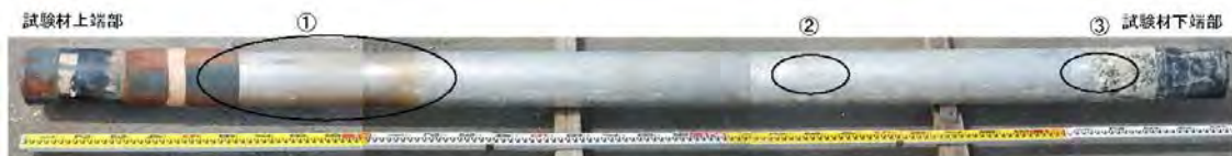
①飛沫帯の試験材表面には、もらい錆による変色(茶褐色)が認められる
