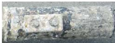
⑤アルミニウム合金陽極の消耗状況
