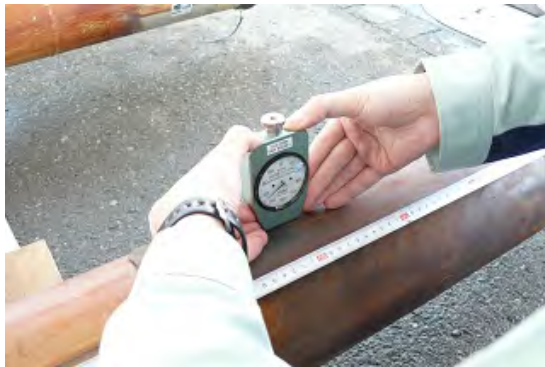
写真-3.3.14.7 ショアD硬度測定状況
