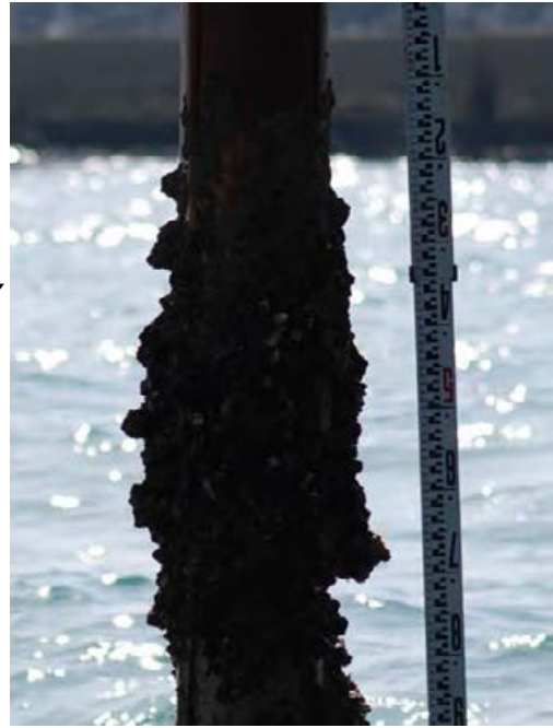
チタン合金片部の生物付着状況
