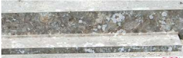
写真-3.3.13.2 試験材 N-13 の生物除去後の現地詳細観察結果(南面)
