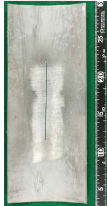
内面/脱スケール後
