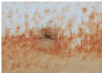
②高耐食性SUS溶接部(異状なし)
