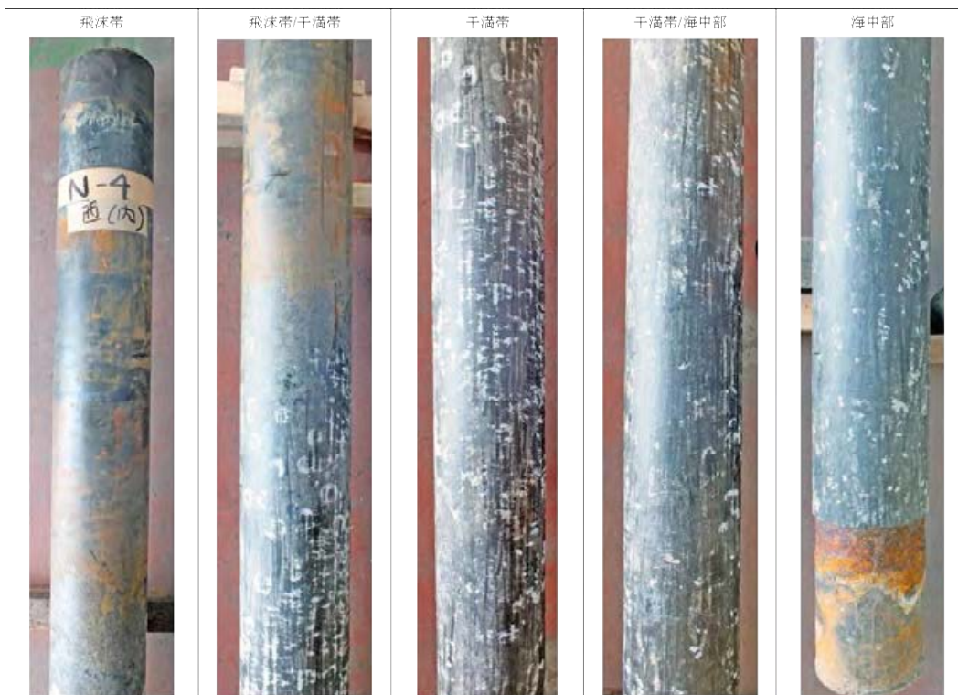
写真-3.3.4.5 N-4 材の各部位における外観（西側）
