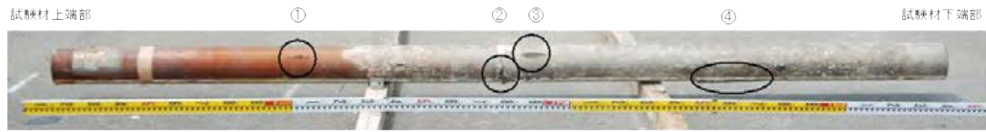
①スクラッチ傷部(傷部内で発錆あり) ③スクラッチ傷部への海生物の侵入が認められる ②シール材が損傷し、チタン箔の一部が剥離
