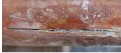
②スクラッチ傷部(海生生物が侵入しチタン箔に浮きが認められる)
