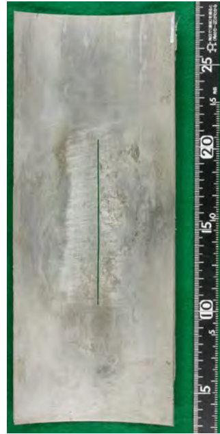
内面／脱スケール後
