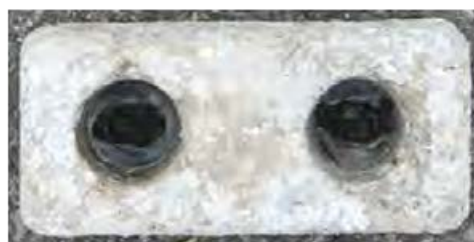
写真-3.3.6.4 陽極外観状況 (試験材 N-6)
