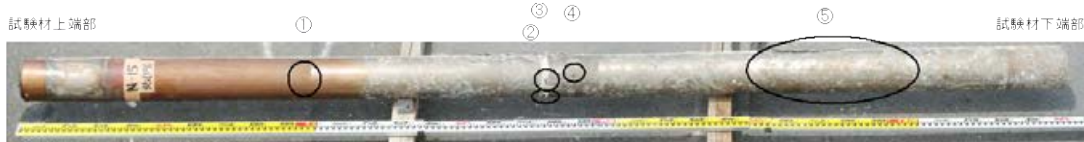
①衝撃痕部(チタン箔が剥離し鋼管が露出) ②シール材およびチタン箔の欠損 ③シール材およびチタン箔の欠損 ④衝撃痕部(異常なし)
