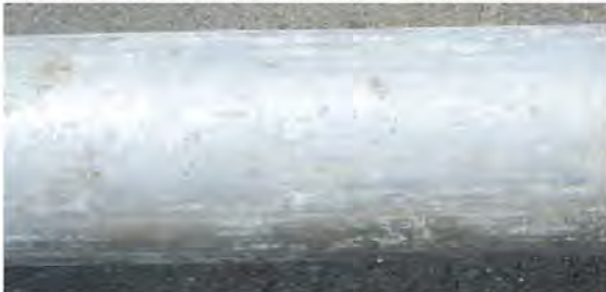
②高耐食性SUS部にすきま腐食などの局部腐食は認められない
