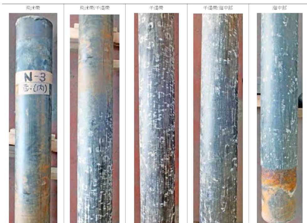
写真-3.3.3.4 N-3材の各部位における外観(西側)
