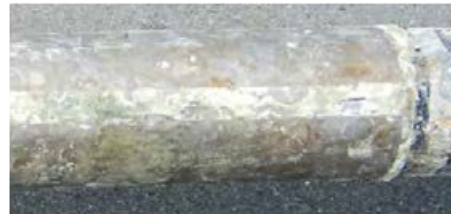
⑤アルミニウム合金陽極の消耗状況
