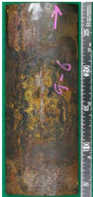
外面／脱スケール前
