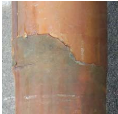
②ウレタン塗膜の欠損
