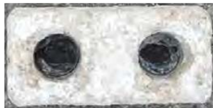
写真-3.3.4.4 陽極外観状況 (試験材N-4)
