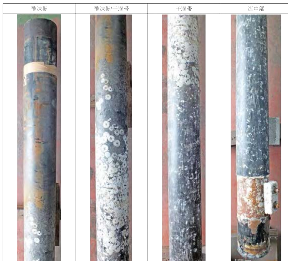
写真-3.3.4.5 N-4 材の各部位における外観（西側）
