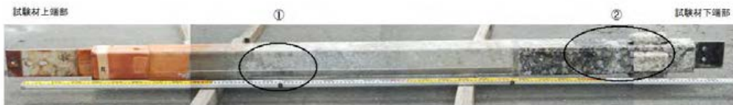
①溶接部状況(局部腐食なし)
