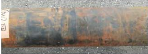
③海生生物(フジツボ類)の付着跡(被覆材に異状は認められない)
