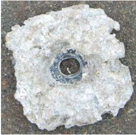
写真-3.3.12.4 試験材 N-12 の陽極の外観状況
