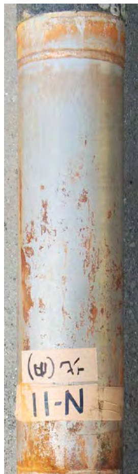
①飛沫帯の試験材表面には、もらい錆による変色(茶褐色)が認められる
