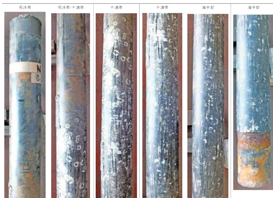
写真-3.3.3.7 N-3 材の各部位における外観(東側)
