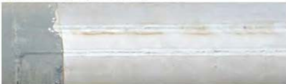
②干渉帯におけるチタン板溶接部(異状なし)
