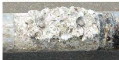
③アルミニウム合金陽極の消耗状況
