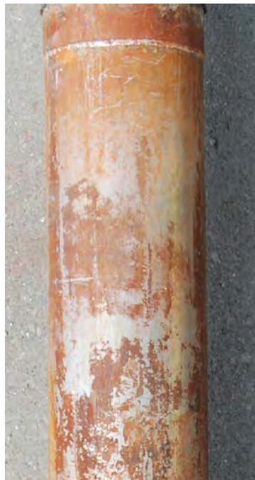
①飛沫帯の試験材表面には、もらい錆による変色(茶褐色)が認められる
