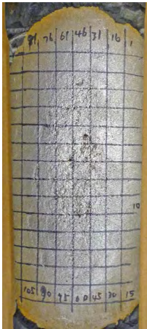
写真-3.3.17.16 人工欠陥部（スクラッチ傷）の状況と板厚減少量（飛沫帯上部）
