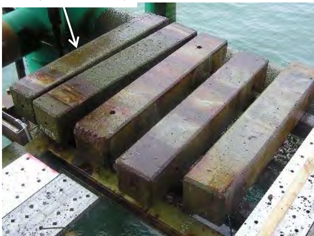
写真-4.1.2 第3デッキ試験体損傷状況（暴露26年）
