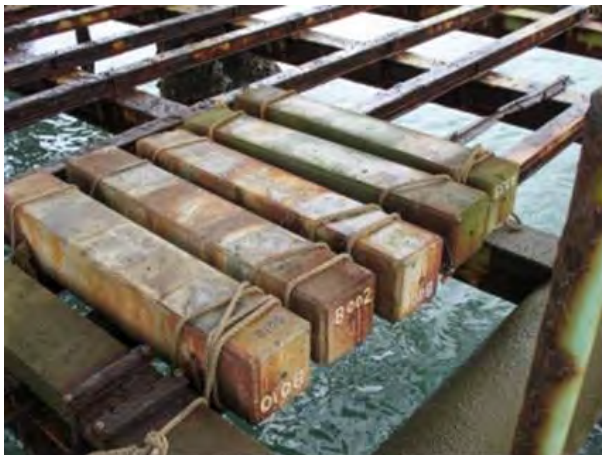
(c) 小型, 中型試験体 (暴露25年まで)
