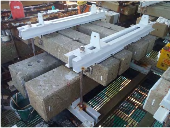
写真-4.1.6 鉄筋応力 140\text{N}/\text{mm}^2 試験体
