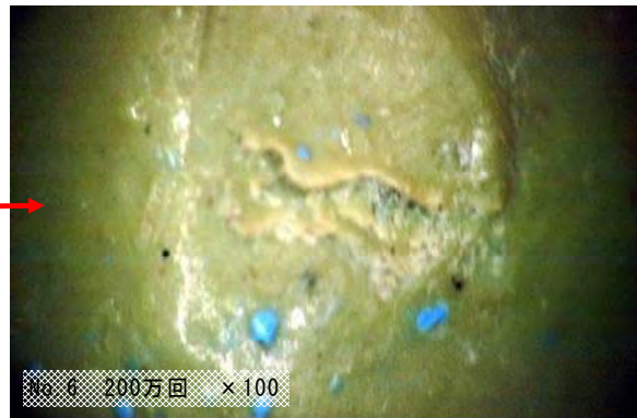
写真-資 6.22 No. 6 位置損傷状況 (B018 試験体)
