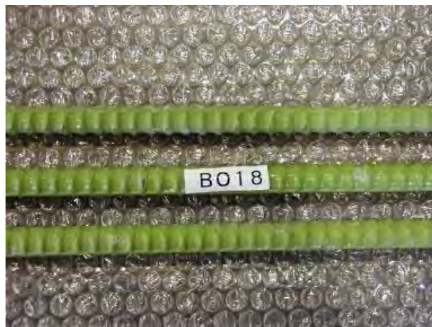
写真-資 6. 16 B018 試験体 (粉体樹脂塗装 3M)
