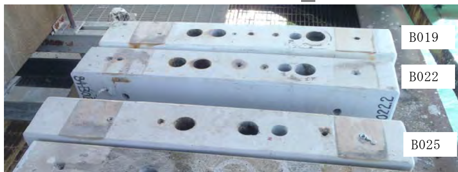
写真-4.1.3 コンクリート塗装試験体
