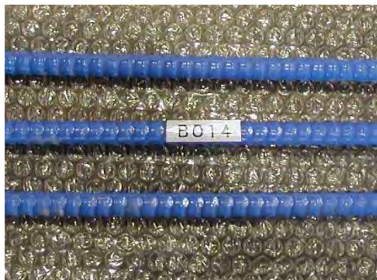
写真-資 6.3 B014 試験体 (粉体樹脂塗装 2)
