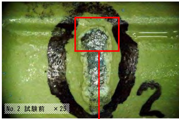
写真-資 6.17 No. 1 位置損傷状況 (B018 試験体)
