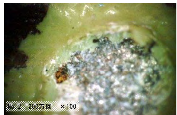
写真-資 6.18 位置損傷状況 (B018 試験体)
