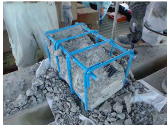
写真-4.5.4 腐食状況（試験体 B092）
