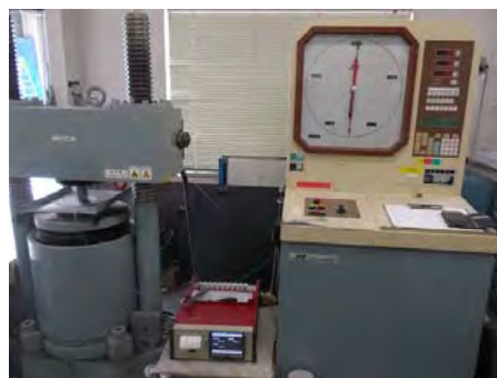
写真-3.2.1 圧縮強度試験状況
