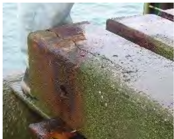
写真-4.1.2 第3デッキ試験体損傷状況（暴露26年）
