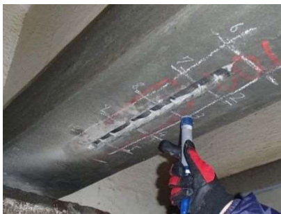
写真 3.3 表面電位計測状況
