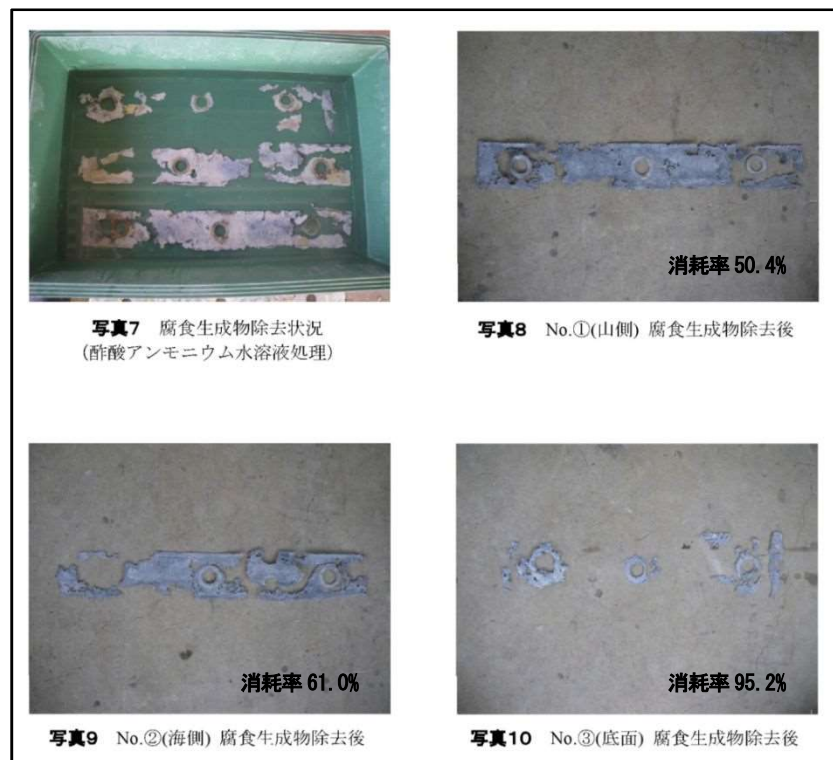
図5.7 亜鉛シート消耗量調査結果
