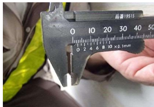
写真-3.1.6 かぶり厚確認 (2～3mm)
