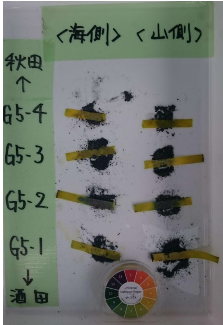
写真-3.2.2 バックフィル材の pH 評価試験
