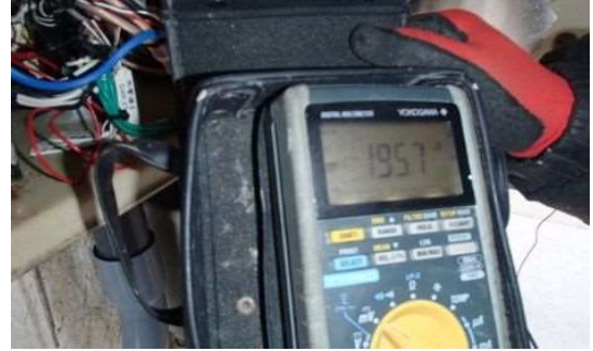
写真-6.2.1 電位値不安定の状況 (17.1mV → 195.7mV)
