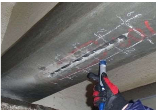
写真-4.1.3 表面電位測定状況
