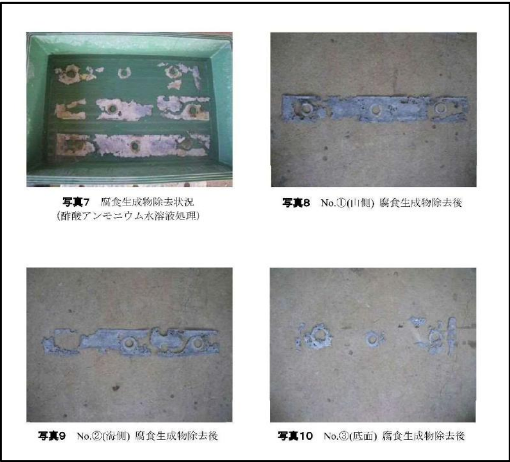
図-5.2.8 酸処理後の陽極状況（亜鉛）
