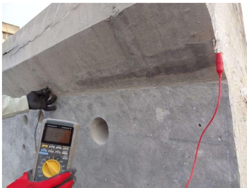
写真-3.1.5 G5-2 におけるディストリビュータと陽極 (表示は31.047mV)
