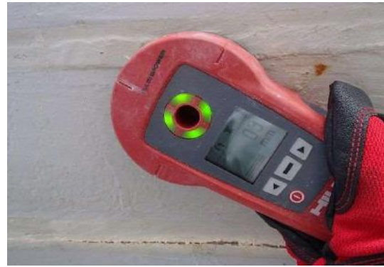
写真-3.1.10 金属片探査状況 (金属片確認)
