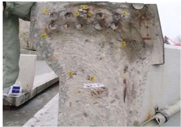
写真-3.1.2 G5-2における鉄筋間導通確認試験
