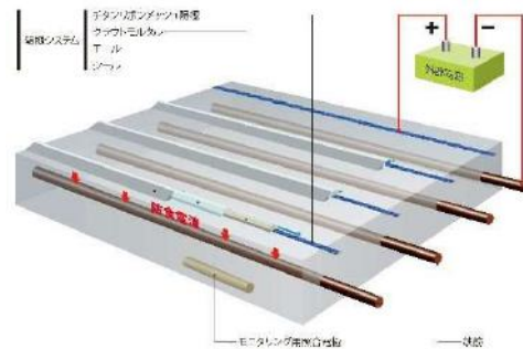
図-3.3.17 貼り付けモールド方式
