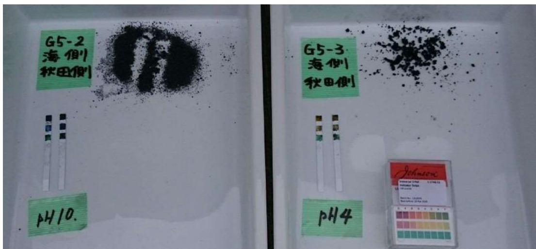
写真-3.2.3 バックフィル材の pH 評価試験
