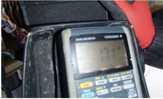
写真-6.2.1 電位値不安定の状況 (17.1mV → 195.7mV)
