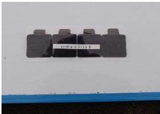
写真-3.7.3 貼付型照合電極
