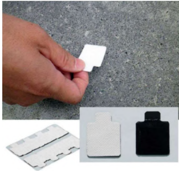
写真-3.3.16 貼り付け型照合電極
