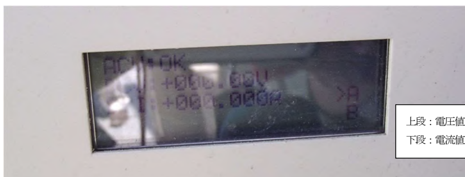
写真-6.5.8 遠隔モニタリング表示値の異常 (No. 5 回路)
