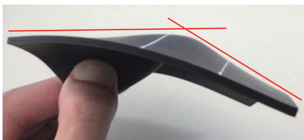
写真 4.1.3 法尻の折れジワ頂角=135°（ゴムによる模擬再現）
