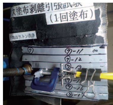
写真 3.2.33 接着力試験状況
