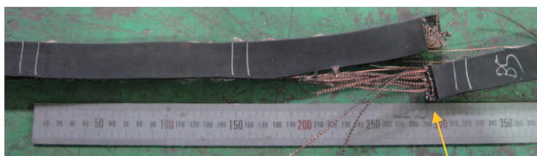
白線 3 箇所が織布突き合わせ接合位置 写真 2.2.18 破断状況
