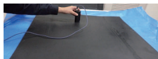
写真3.1.4 打音測定状況
