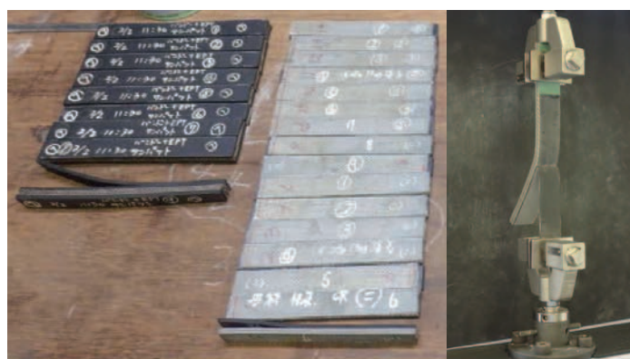
写真 3.2.8 接着強度試験
