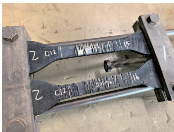
写真 2.2.39 クラック発生状況(②：20%伸長 48h)
