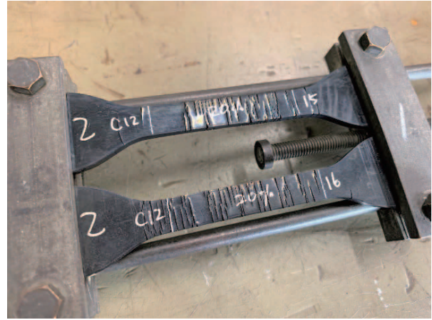
写真 2.2.30 クラック発生状況(② : 20%伸長 48h)
