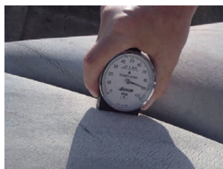
写真 2.1.18 外層ゴムの硬度計測（折れシワ部=90）
