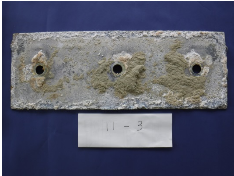
写真-5.5.3.7 陽極撤去後 11-3
