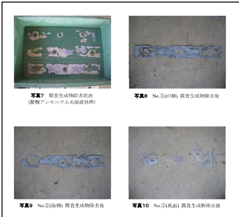
図-4.5.8 酸処理後の陽極状況（亜鉛）
