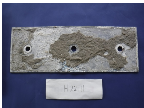
写真-5.5.3.23 陽極撤去後 H22-11
