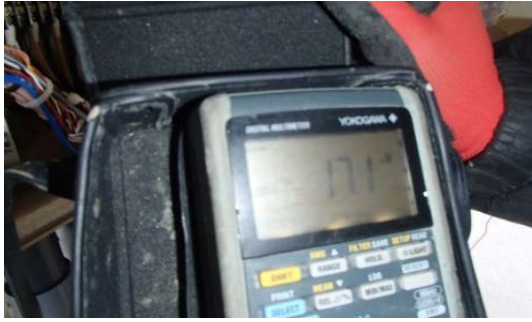
写真-4.6.1 電位値不安定の状況 (17.1mV → 195.7mV)
