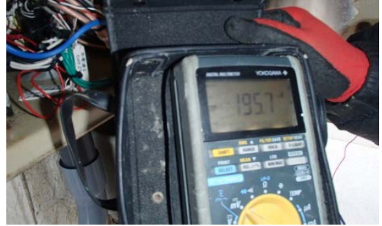
写真-4.6.1 電位値不安定の状況 (17.1mV → 195.7mV)
