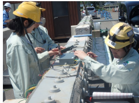
写真-5.5.2.6 表面電位測定状況
