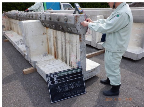
写真-5.5.2.1 導通確認状況
