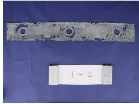
写真-5.5.3.6 陽極表面処理後 11-2
