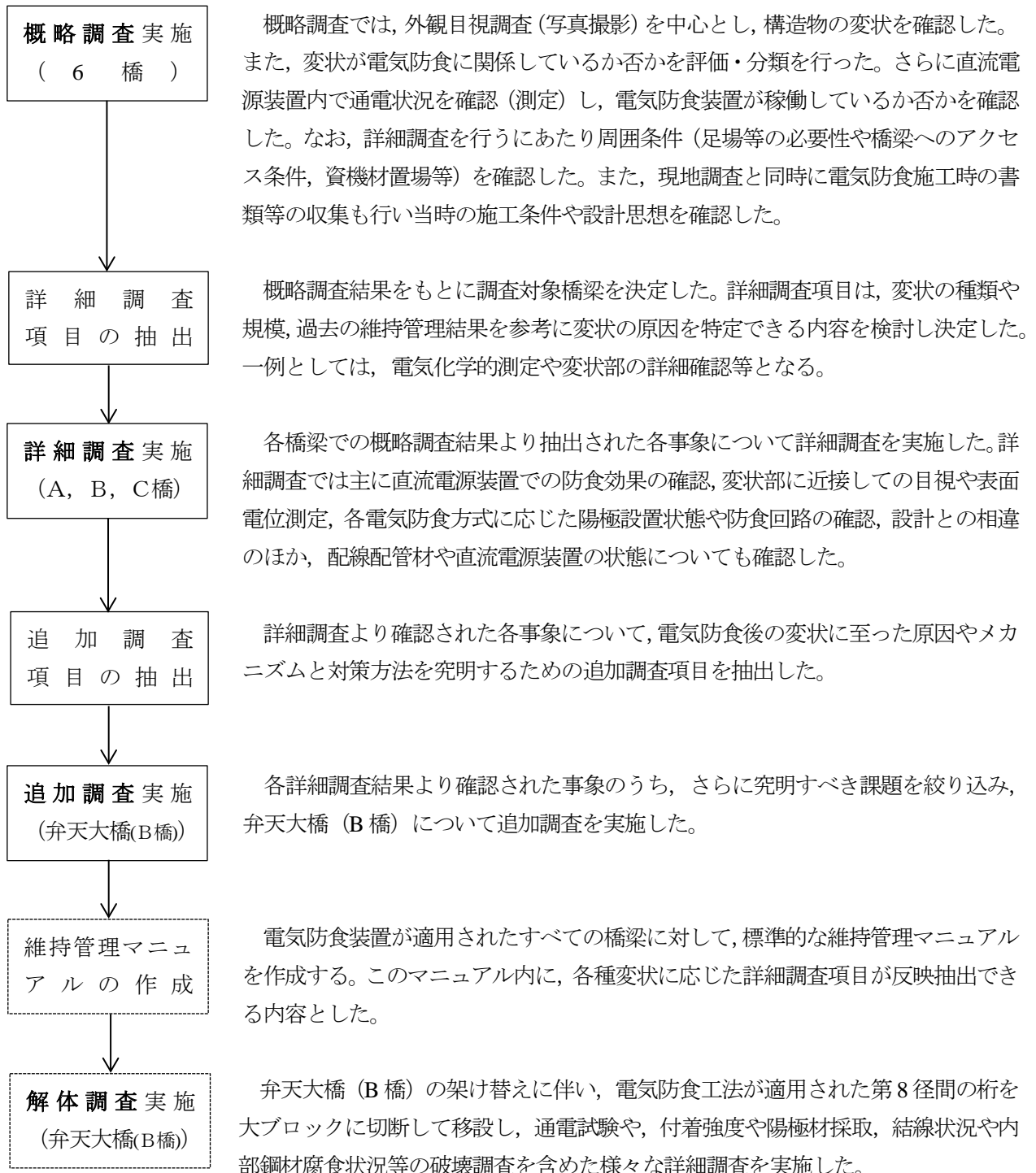
図-1.2.1 弁天大橋解体調査までの実橋調査の流れ
