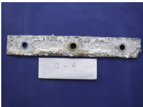
写真-5.5.3.19 陽極撤去後 12-4
