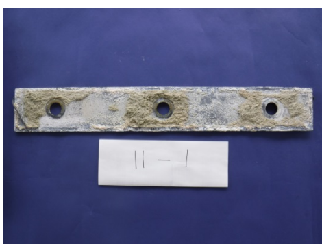
写真-5.5.3.3 陽極撤去後 11-1
