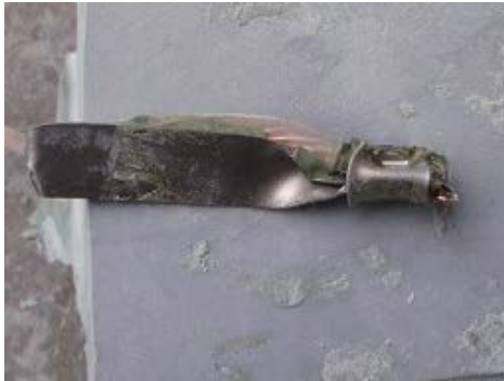
写真-5.4.5.3 ディストリビュータと電線の結線
