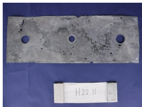
写真-5.5.3.24 陽極表面処理後 H22-11
