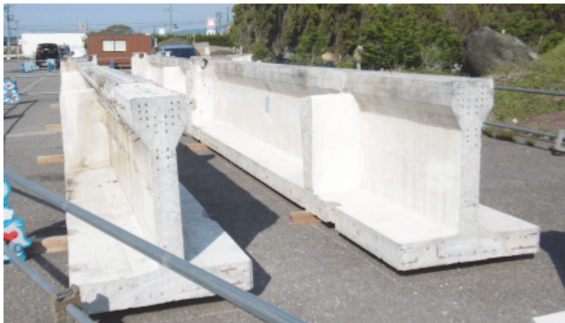
図4-14 測定対象とした部材の設置状況（上下反転して設置）
