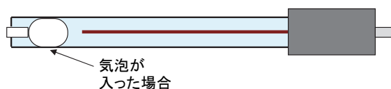
図 2-5 基準電極の液絡部近傍に気泡が混入した場合の例
