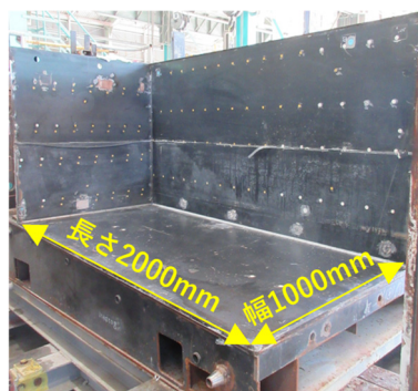
a) 型枠の状況
