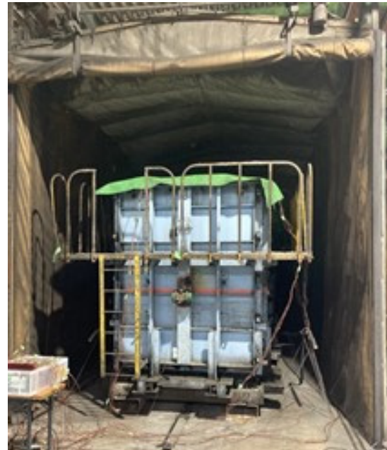
図 2-10 ボックスカルバート試験体を用いた実験における蒸気養生設備の正面写真
