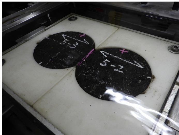
写真 2.6 ハンブルクホイールトラッキング試験供試体設置状況
