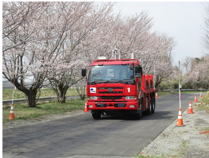
写真 2.3 促進载荷試験の状況
