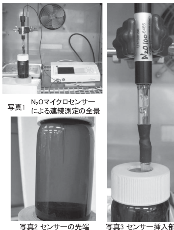
図-2 連続測定実験の写真
