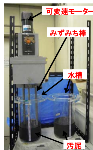
図 実験装置 (左：みずみち棒あり 右：みずみち棒なし)
