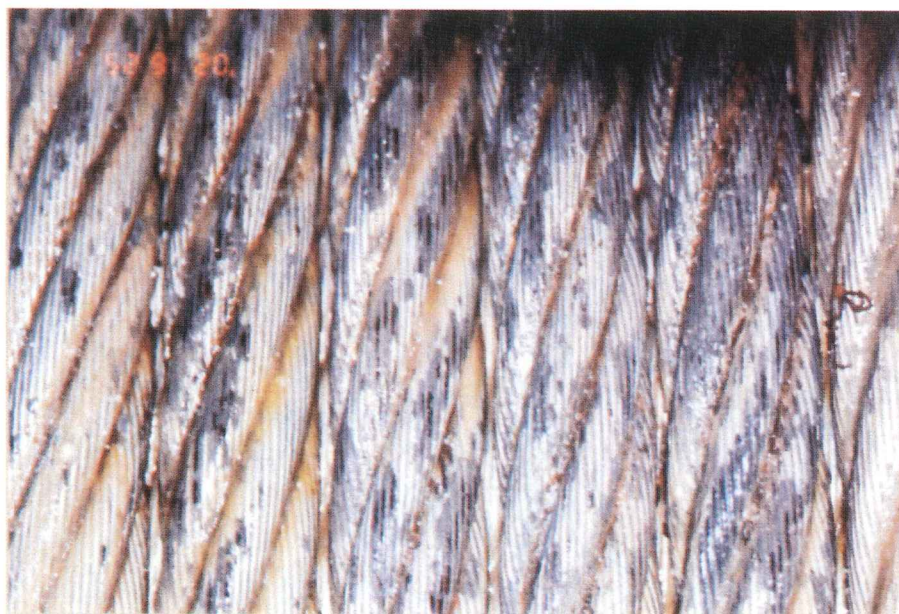
写真解-5.3 亜鉛めっきワイヤロープの亜鉛素地面からの溶出例
