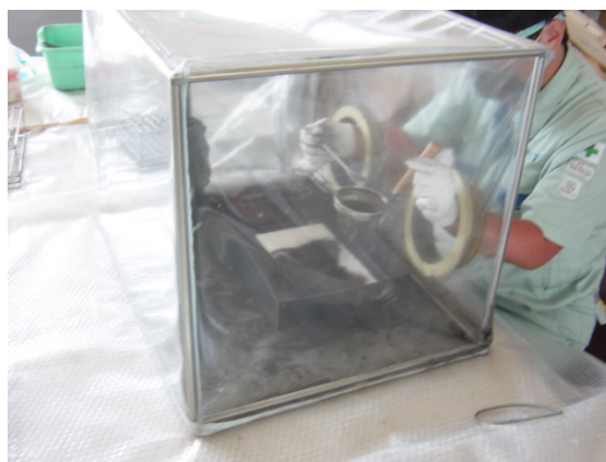
写真5.3-1(2) 汚れ物質のふり掛け
