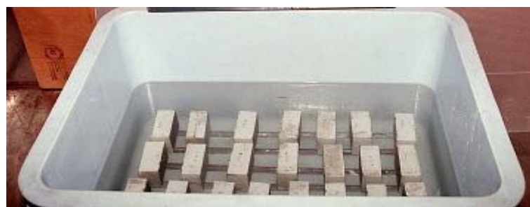
写真-Ⅲ.1.2 試験体の浸漬状況
