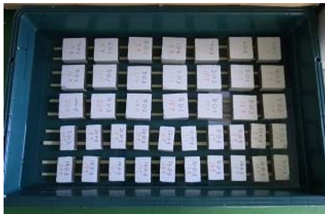
写真－Ⅲ. 1. 15 試験体の浸漬状態
