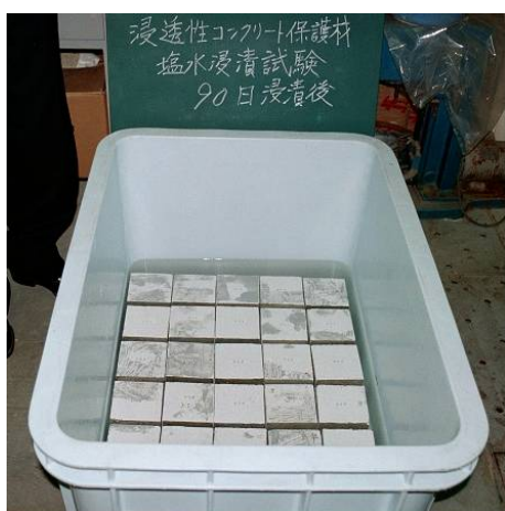
図-III.1.8 塩化物イオン浸透性試験方法
