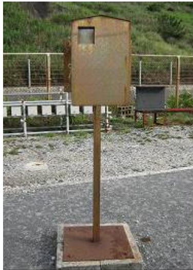
写真－Ⅲ.1.13 土研式飛来塩分補集器
