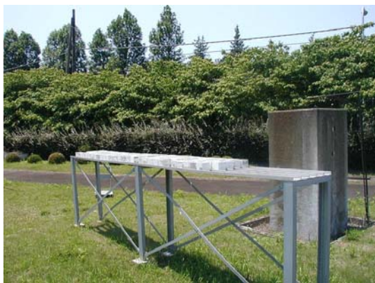
写真－Ⅲ.1.5 つくば暴露試験状況
