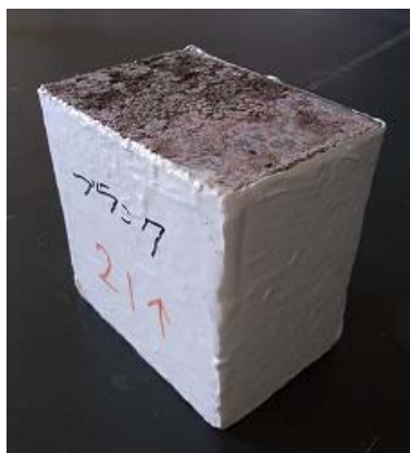
写真－Ⅲ. 1. 14 シール後の試験体
