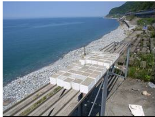
写真－Ⅲ.1.8 親不知暴露試験状況
