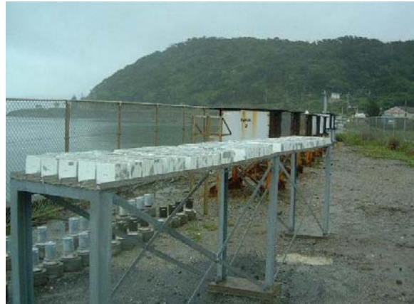
写真－Ⅲ.1.9 沖縄暴露試験状況
