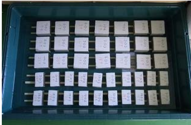
写真－Ⅲ.2.1 試験体の浸漬状態
