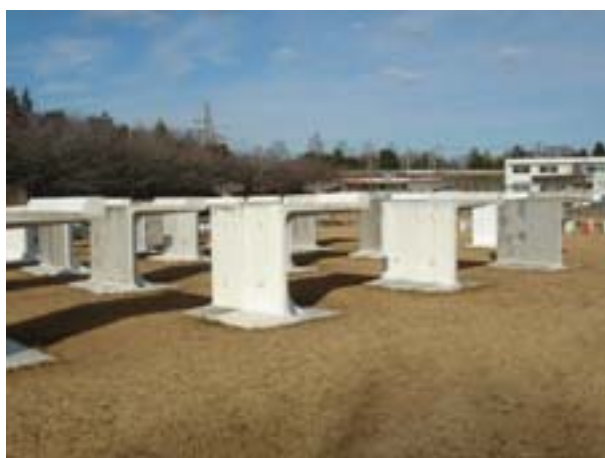
写真-IV.2.2 つくば暴露7年の大型試験体の外観
