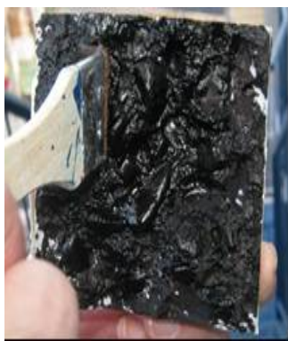
付属図－4.2 墨汁法による浸透深さの測定フロー
