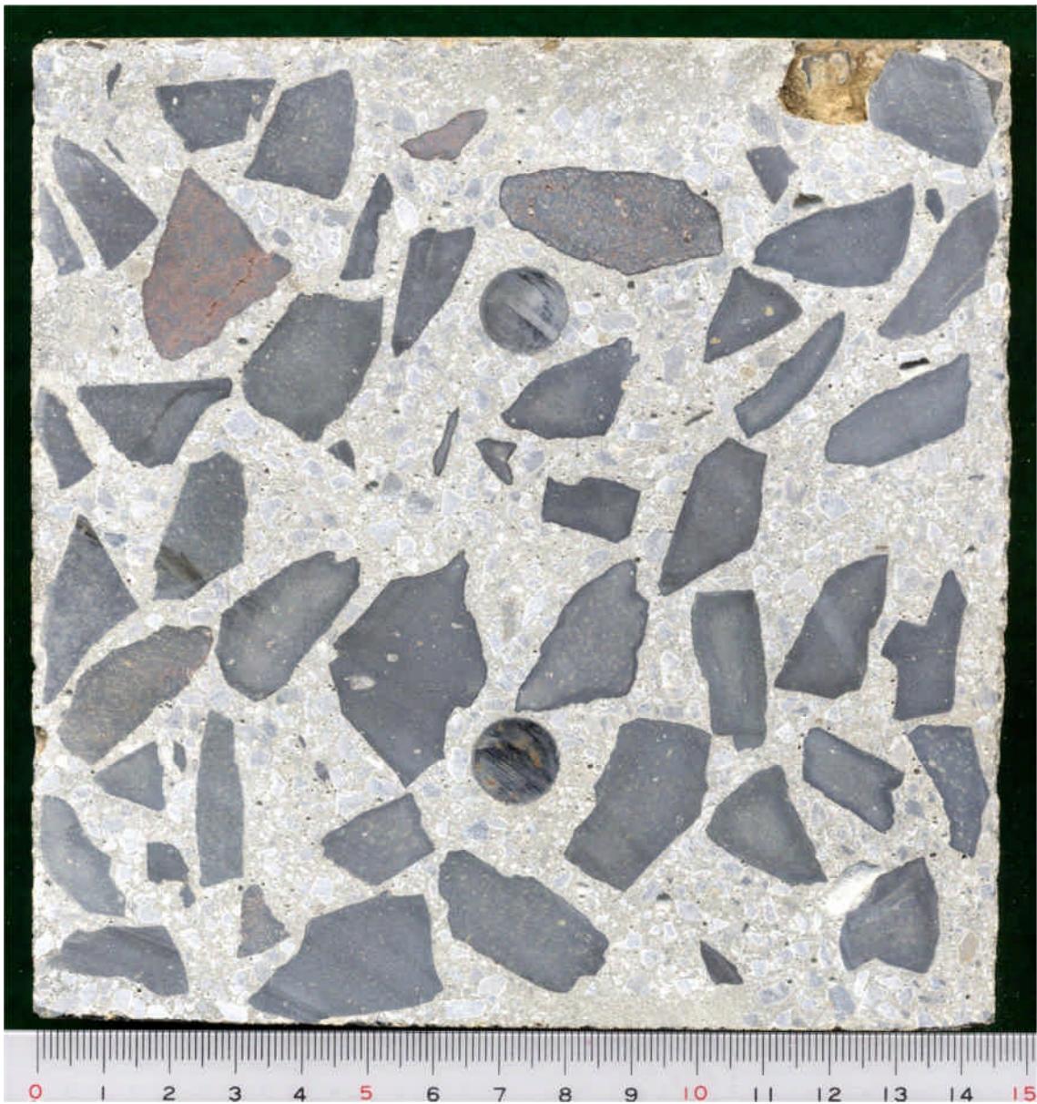
付図-4.8.1 供試体切断面 (89096 3A)
