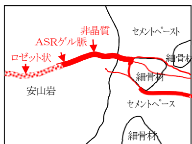
付図-4.2.4 偏光顕微鏡写真 (89093 3A, 安山岩)
