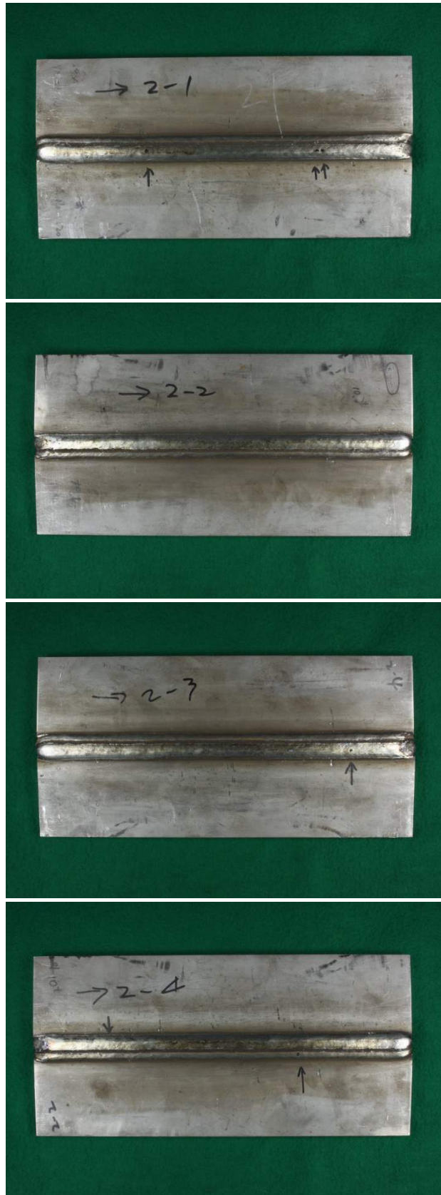
写真 3. 2. 2 SUS323L 追加設置分溶接材外観
