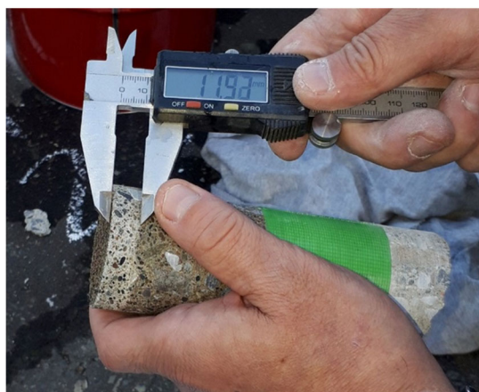
解説 図-5.3.3 含浸層（吸水防止層）の確認の様子（塗布 16 年経過）〔含〕
