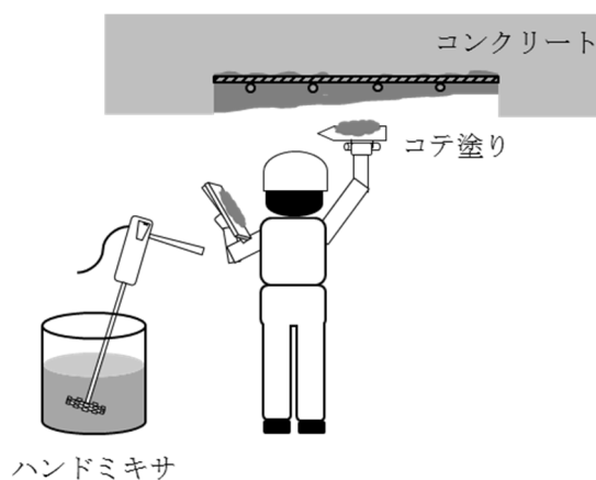
解説 図-3.6.1 左官工法の例
