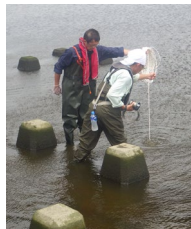
ハイロート式採水器による採水
