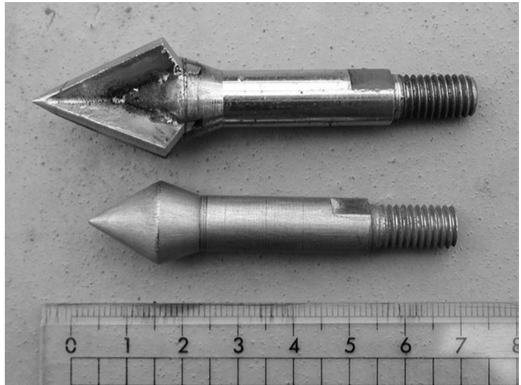
写真 4 2 先端コーンの形状 (上がベーンコーン、下が土検棒貫入試験の先端コーン)
