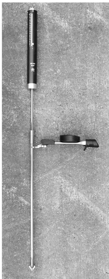
写真 8 1 ベーンコーンせん断試験の外観
