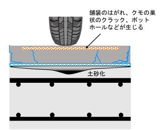
※)土砂化層に隣接して中間層の存在が 指摘されている
