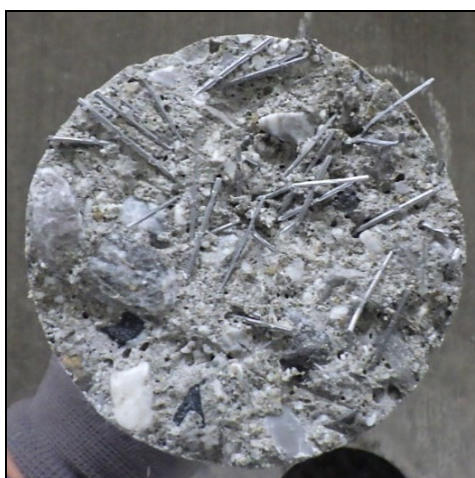
(h) No. 8 ( \phi 80 ) (左側：コア, 右側：鋼床版) SFRC 舗装材料破壊
