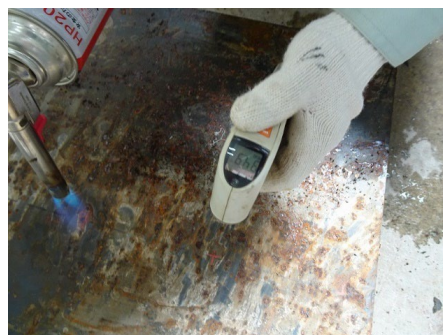
写真-2.4.3 トーチバーナによる加熱と温度測定
