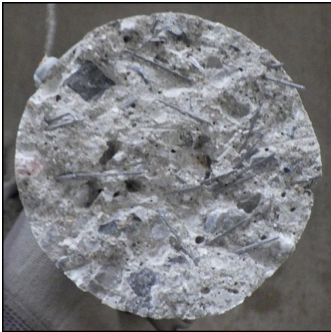
(i) No. 9 (φ80) (左側：コア, 右側：鋼床版) SFRC 舗装材料破壊
