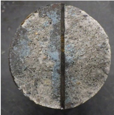
(a) ケース 3 STEP3 No. 1 (材料破壊, 界面破壊)
