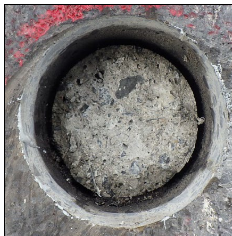
(a) No. 11 ( \phi 80 ) (左側：コア，右側：鋼床版) SFRC 舗装材料破壊
