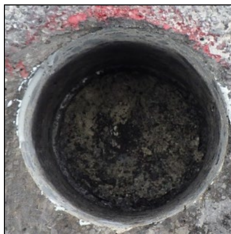
(b) No. 12 ( \phi 80 ) (左側：コア，右側：鋼床版) SFRC 舗装材料破壊
