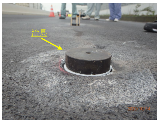
写真-4.2.7 治具接着状況
