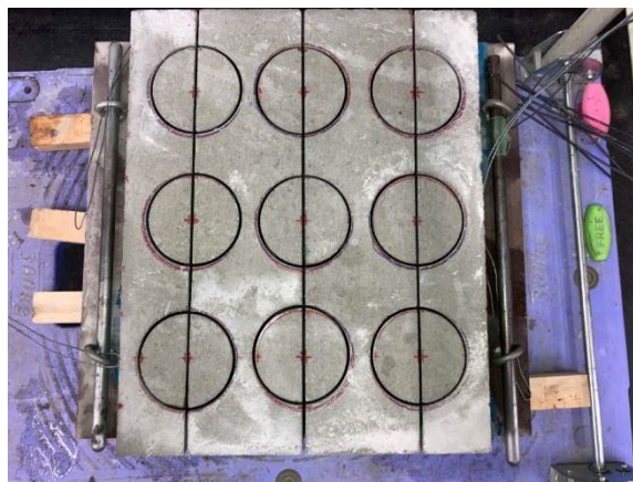
写真-2.1.15 コア切削後の小型試験体
