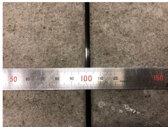
写真-2.1.12 カッターにより導入した 模擬貫通ひび割れ (3mm 幅)
