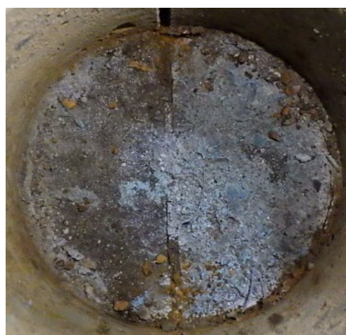
(a) ケース 2 STEP2 No. 1 (材料破壊, 界面破壊)
