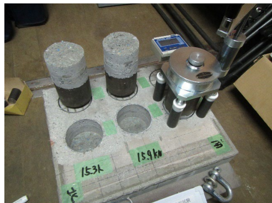
写真-3.4.5 引張接着強度試験状況
