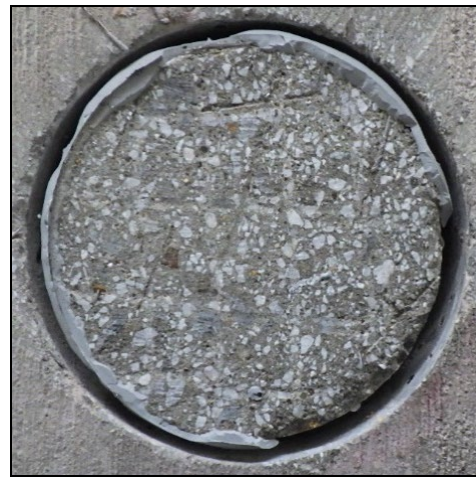
(c) No. 3 ( \phi 100 ) (左側：コア, 右側：鋼床版) 治具用接着剤での破壊
