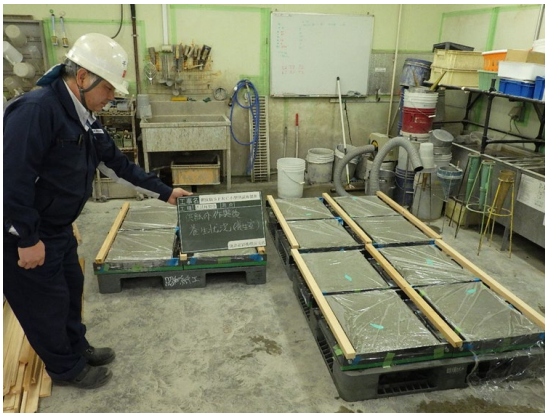
写真-2.1.9 養生状況 (⑧)
