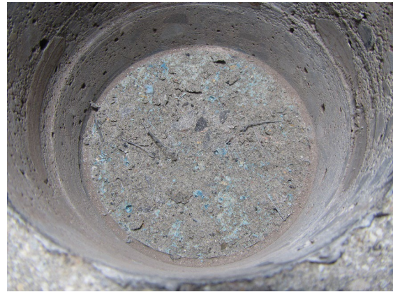
(a) No. 4 (左側：コア, 右側：鋼板) (材料破壊および凝集破壊)
