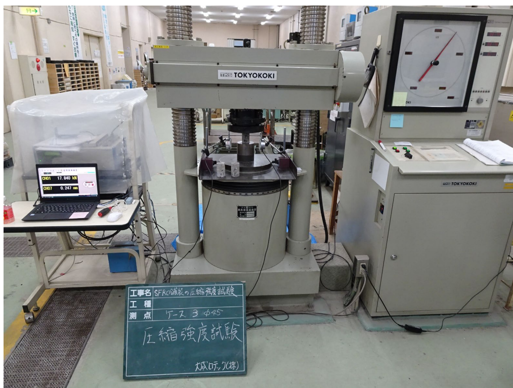
写真-2.4.6 圧縮強度試験機
