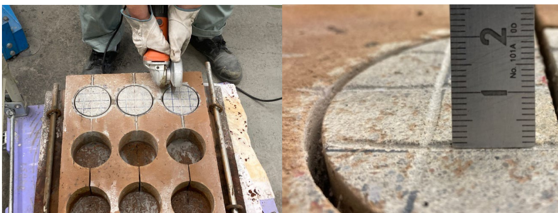
写真-2.1.20 試験体表面の整形状況
