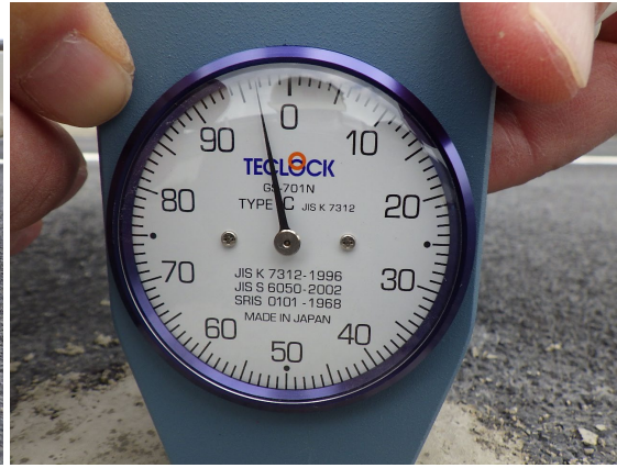
写真-4.2.12 デュロメーターによる確認
