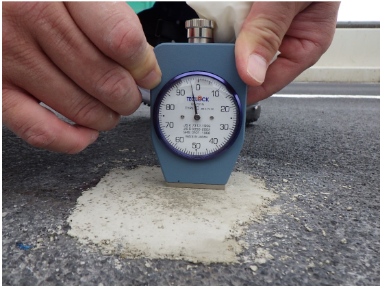
写真-4.2.12 デュロメーターによる確認
