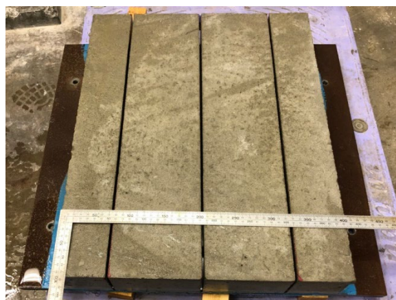
写真-2.1.13 模擬貫通ひび割れ試験体
