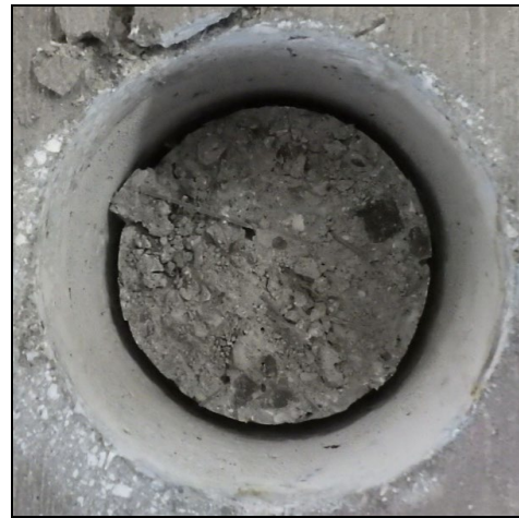
(i) No. 9 (φ80) (左側：コア, 右側：鋼床版) SFRC 舗装材料破壊
