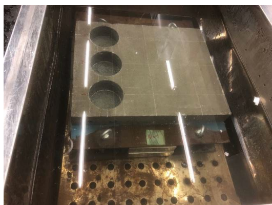
写真-2.1.16 温水負荷状況（左：ケース1，ケース2 右：ケース3）
