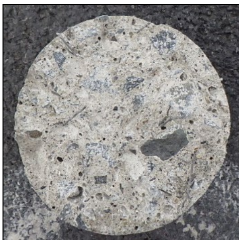
(a) No. 11 ( \phi 80 ) (左側：コア，右側：鋼床版) SFRC 舗装材料破壊
