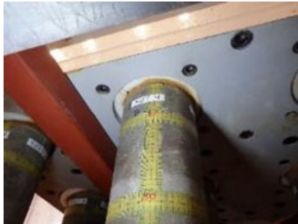
写真-2.3.2 既設杭模型とフーチング模型の結合部
