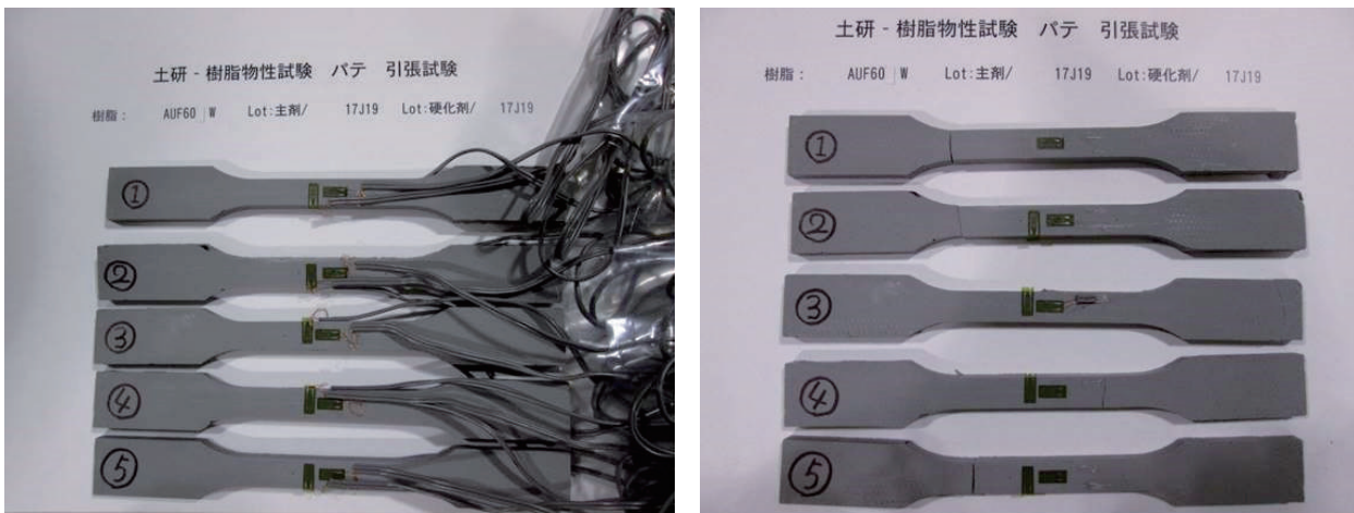
写真-3.3.4 パテ試験片の破壊様相
