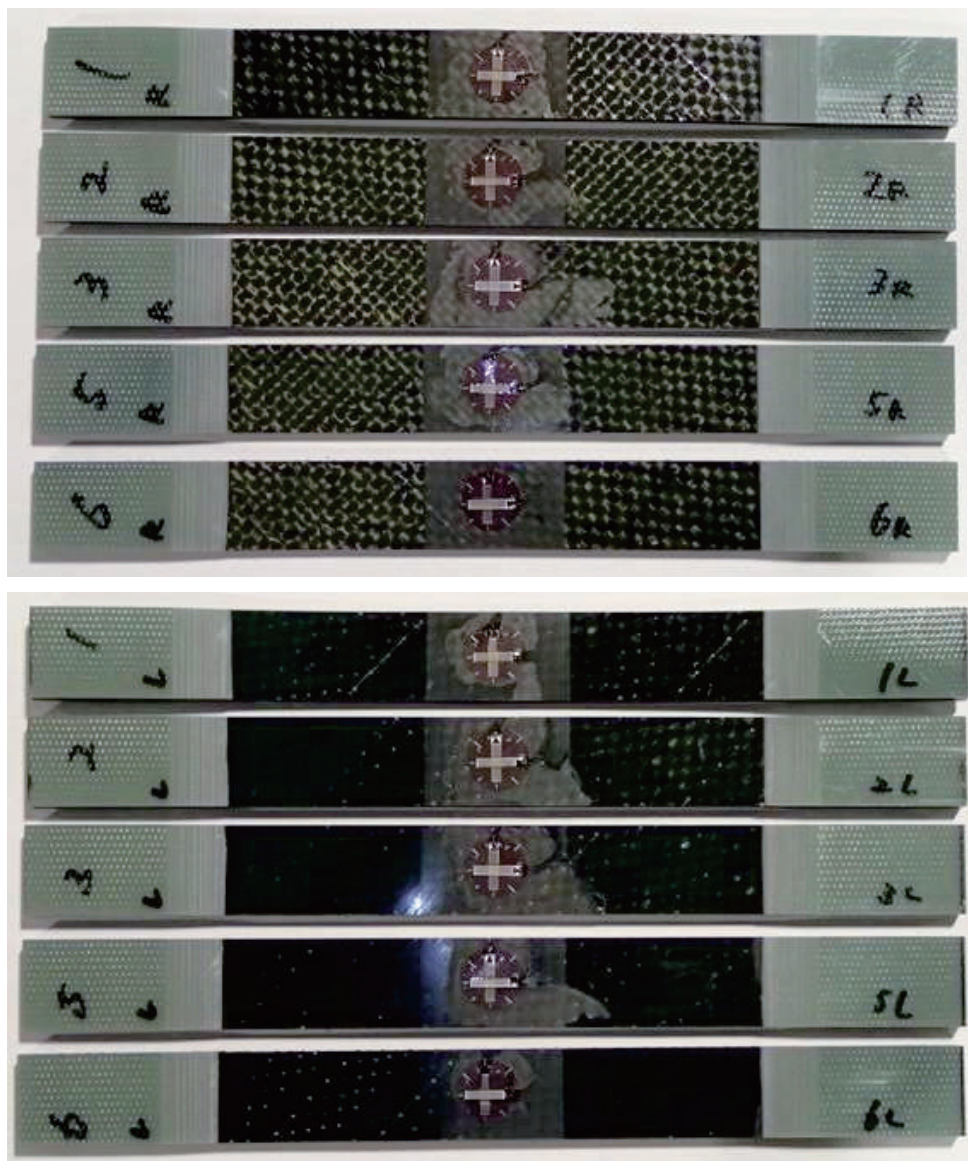
写真-3.2.4 炭素繊維シート試験片の破壊様相
