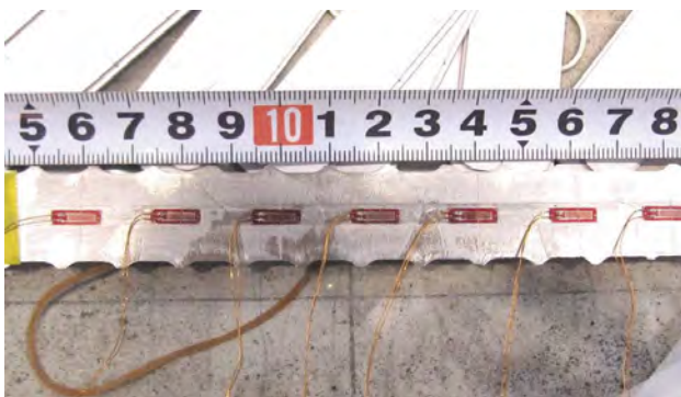
図-2.2.5 半割鉄筋内側のひずみゲージ貼付状況
