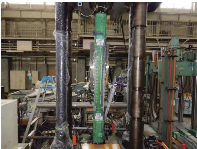
図-2.6.2 連続繊維シートが接着された面 (A面)
