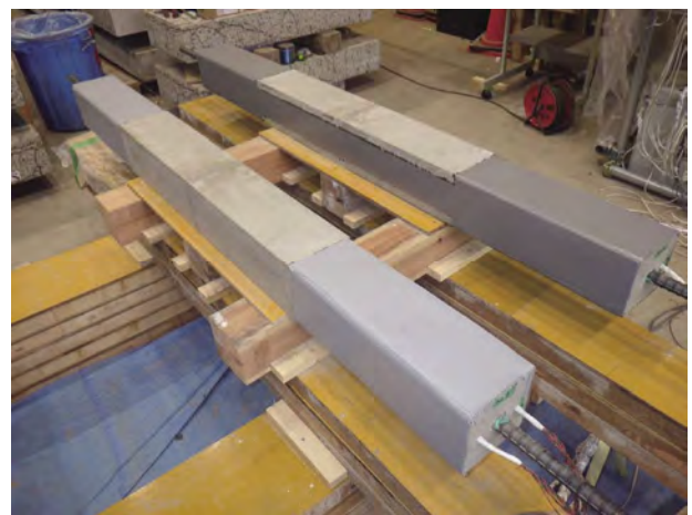
(d) パテの施工
