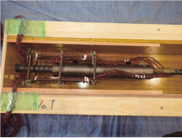
図-2.3.2 型枠内のスリーブ周辺
