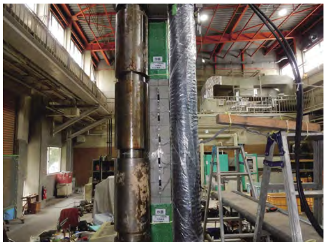
図-2.6.3 連続繊維シートが接着されていない面 (B面)
