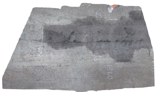
(d) タイムスライス断面1の滞水の様子
