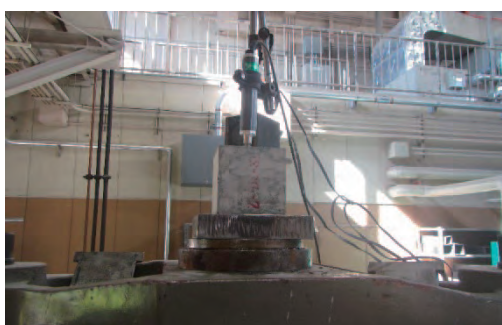
写真-4.11 引抜き試験状況
