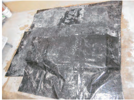
写真-4.6 養生状況
