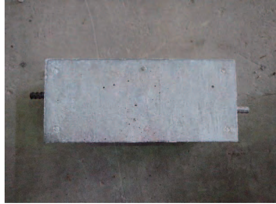
写真-5.7 コンクリート供試体
