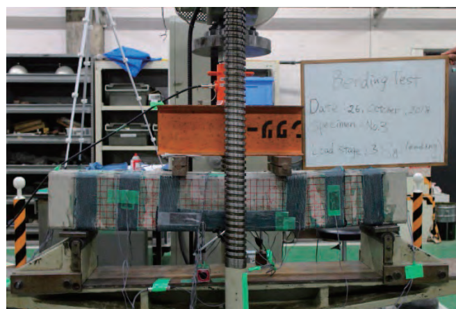
写真-7.2 3d_y 時の供試体 CCN-2 の様子
