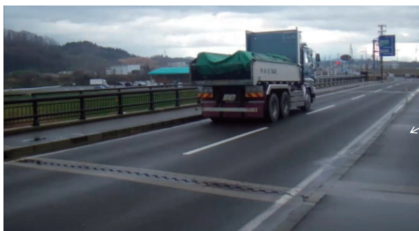
図-3.3.1 走行載荷試験の状況
