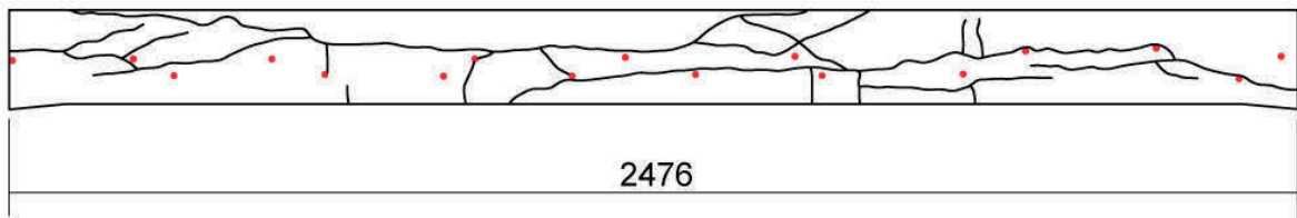
(b) 撤去後の床版切断面
