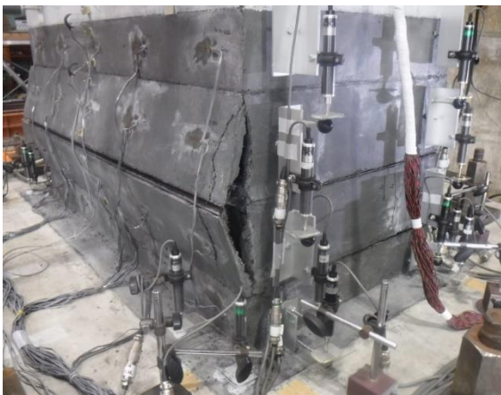
写真-4.4.45 +6 \delta_y 3 回目 圧縮側柱基部
