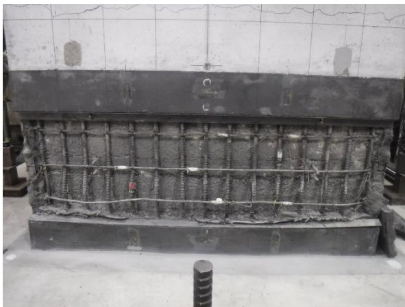
写真-4.4.73 実験終了後 正載荷圧縮側
