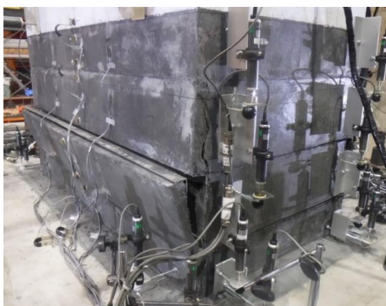
写真-4.4.43 +10 \delta_y - 3 回目 圧縮側柱基部
