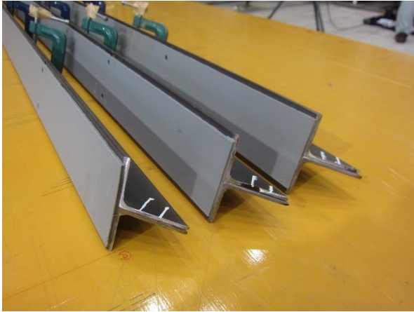
写真-4.4.34 No.3 目地材の端部の形状
