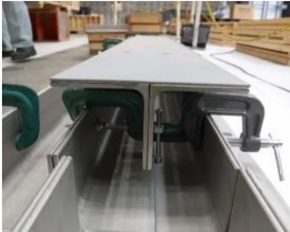
写真-4.4.1 ひび割れ誘発目地
