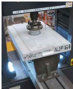
(c) 押し抜き試験状況
