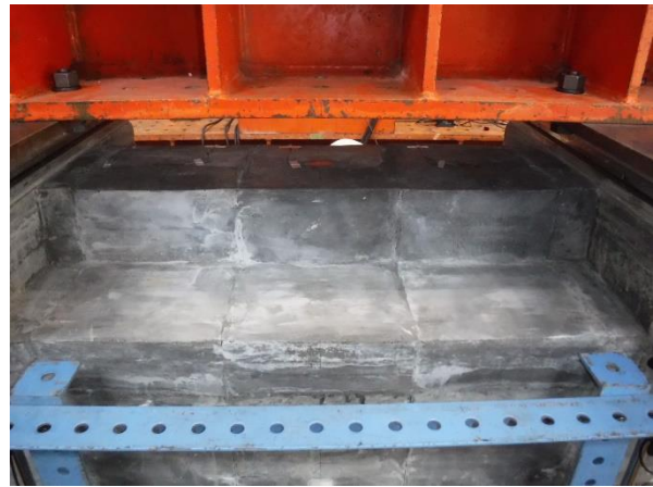
写真-4.4.23 等曲げ区間 圧縮側の状況
