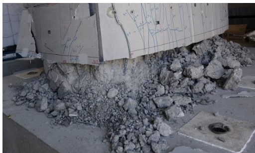
(d) Case-3 (PHb+CF パネル補強) CF パネル除去時の内部コンクリート
