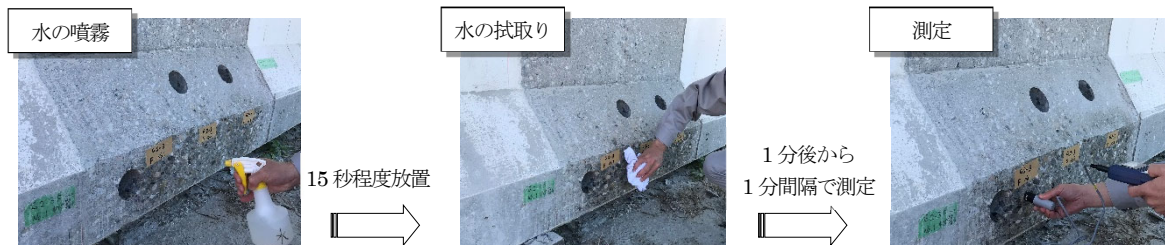
図 4.3.3 撥水性確認の測定概要
