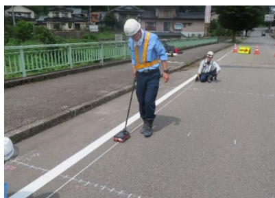
写真 1-3-3 ハンディ式 電磁波レーダ
