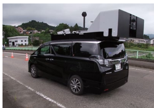
写真 1-3-7 MMS (Mobile Mapping System) 計測
