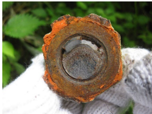
2) 遅れ破壊の破面
