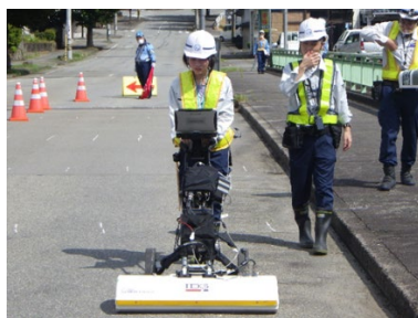
写真 1-3-4 カート式 電磁波レーダ
