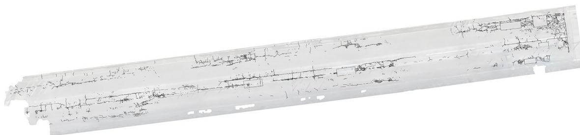
図-4.6.7 舗装面の亀裂分布
