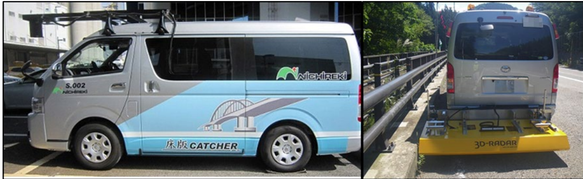
写真-3.3.1 床版キャッチャー外観
