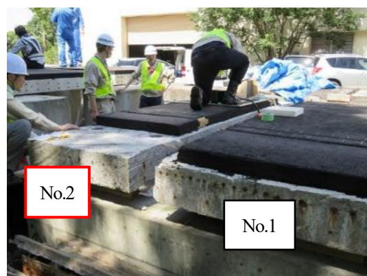
図-5.5.11 測定した撤去床版活用供試体
