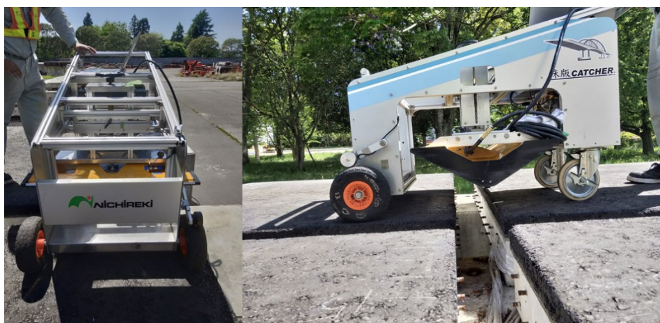
写真-5.2.1 手押し型の電磁波レーダ装置外観（左：正面，右：側面）
