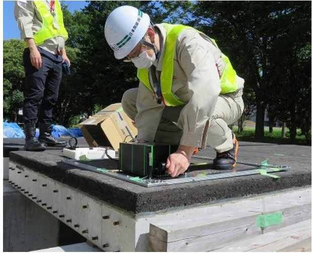
超音波プローブを測定面に押し付けて測定
