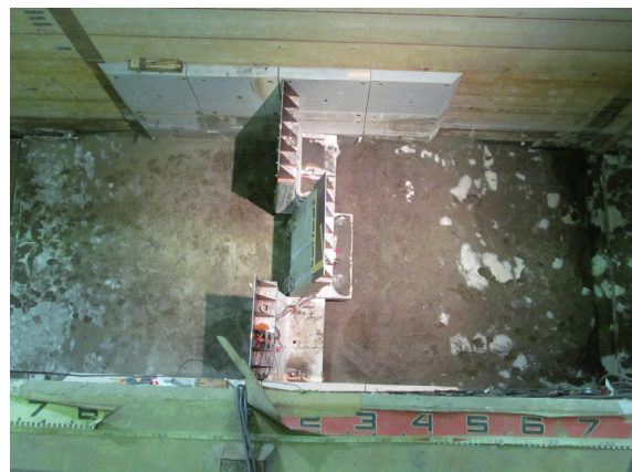
写真-8 地震動と津波を同時に作用させたあとの様子
