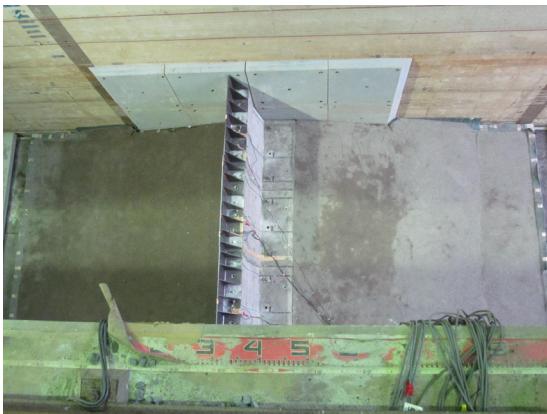
写真-6 防潮壁に対して地震動のみ作用させたあとの様子
