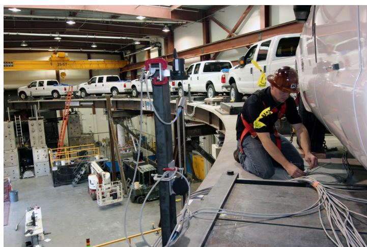
写真-9 ネバダ大学による載荷車両が橋の地震応答に及ぼす影響に検証振動台実験 (写真：実験代表者であるネバダ大学 Ian Buckle 教授提供（作業部会 G メンバー）)
