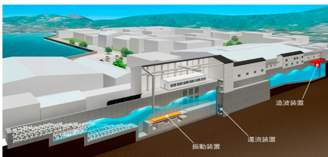
図-1 現在の大規模波動地盤総合水路の外観と各種装置
