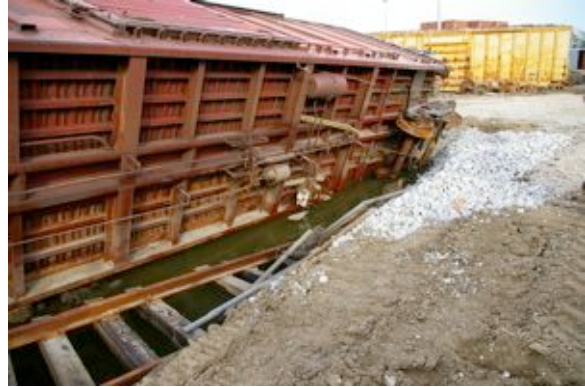
破堤部付近で洗掘等により転倒した貨車
