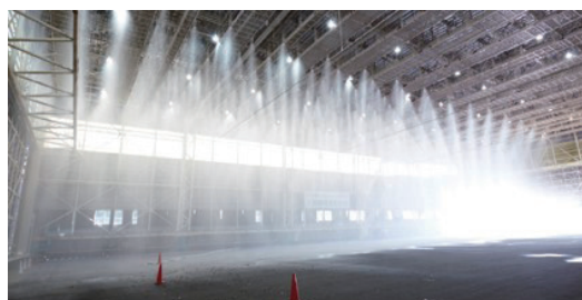
Large-scale Rainfall Simulator 大型降雨実験施設
