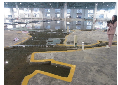
Hydraulic model of the Pearl River Delta near Macau 珠江デルタの水理モデル（マカオ付近）
