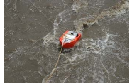
開発中の船の写真； 洪水中の実河川における試験
