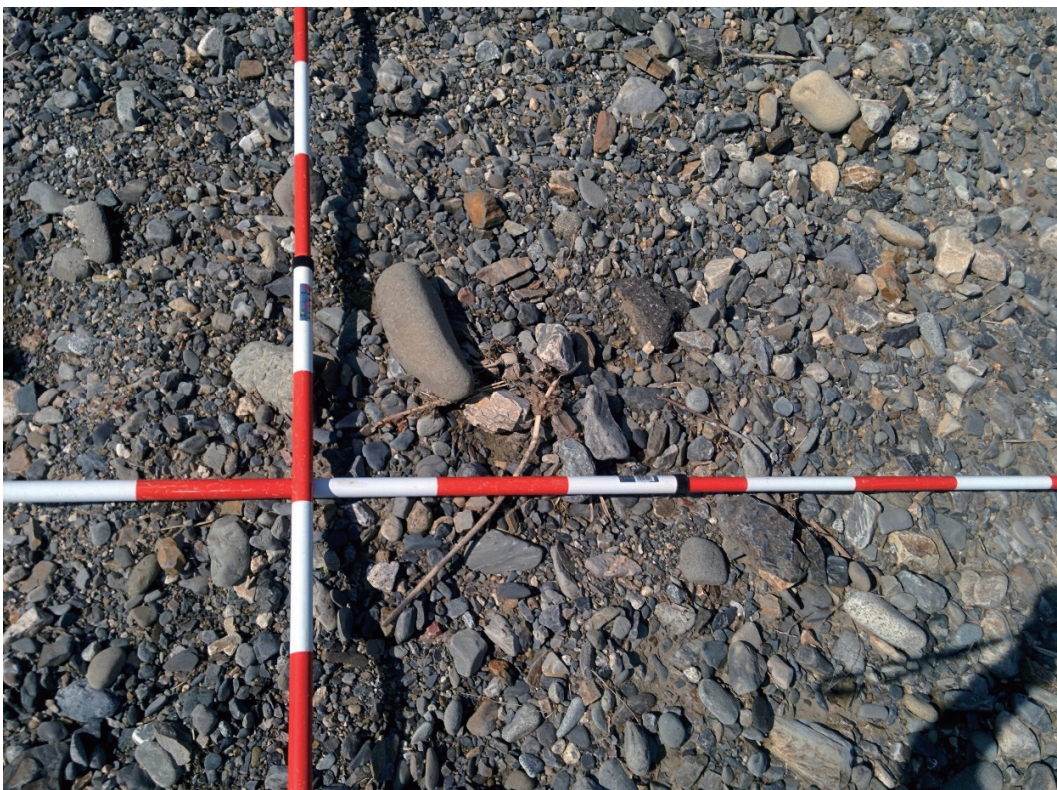
写真 A-9 襲野地区の氾濫堆積物の土砂粒度分布 破堤によって堤内地（農地）に流入した土砂 （図 3.3-5 参照）
