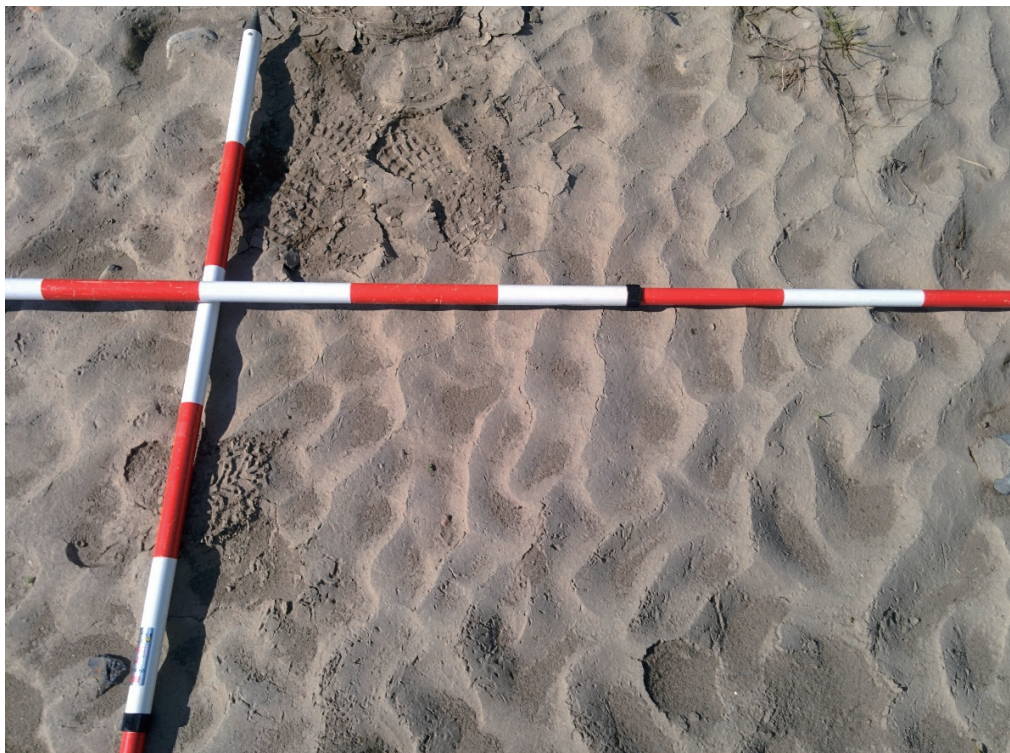
写真 A-11 褒野地区の氾濫堆積物 流路の近くに礫が堆積し、より河道から遠い場所には細粒土砂が堆積していた（図 3. 3-5 参照）
