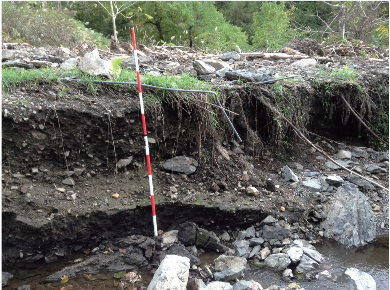
写真 3.3-7 旧堆積物が洪水流によって浸食され、形成された河岸（写真左側が上流）
