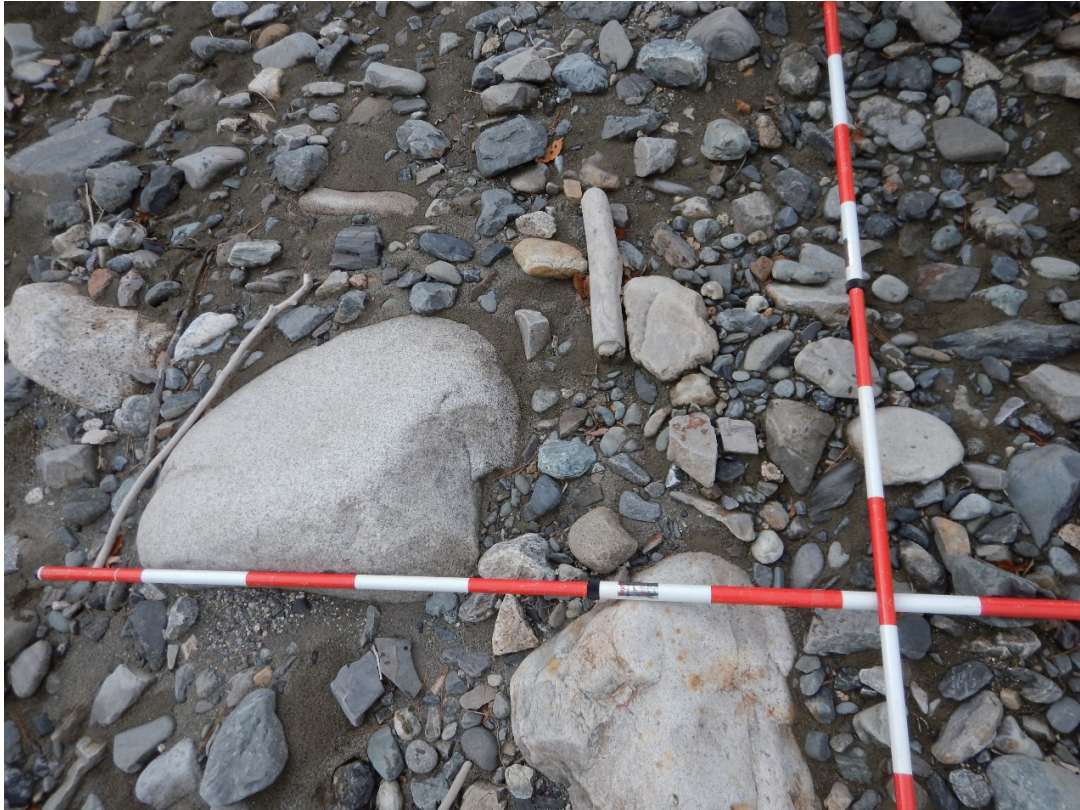
写真 A-19 乙茂地区の河岸材料 福祉施設上流側の湾曲部には表層に巨礫が露出しており強い洪水流が作用したと推察される (4.4 章参照)
